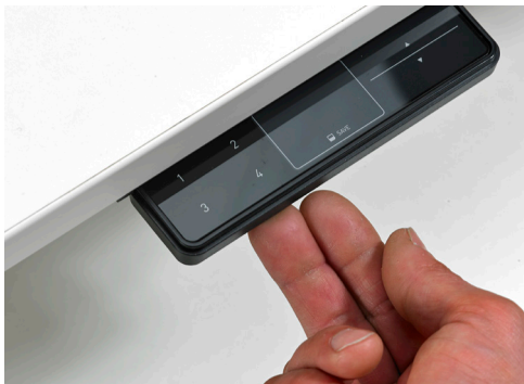
Abb. 33: Bedienteil in horizontale Lage anheben und drücken zum Einschieben
