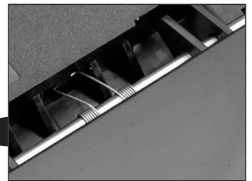
Abb. 36: Ende der Feder in Nase unter dem Schlitten eingehakt
