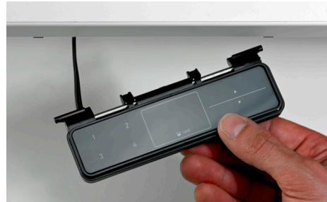
Abb. 35: Bedienteil von oben aus der Verankerung gelöst
