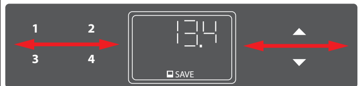
Abb. 50: Aktivierung und Deaktivierung der Sperre beim LegaDrive Touch Comfort Handschalter erfolgt durch Wischen nach links oder rechts
