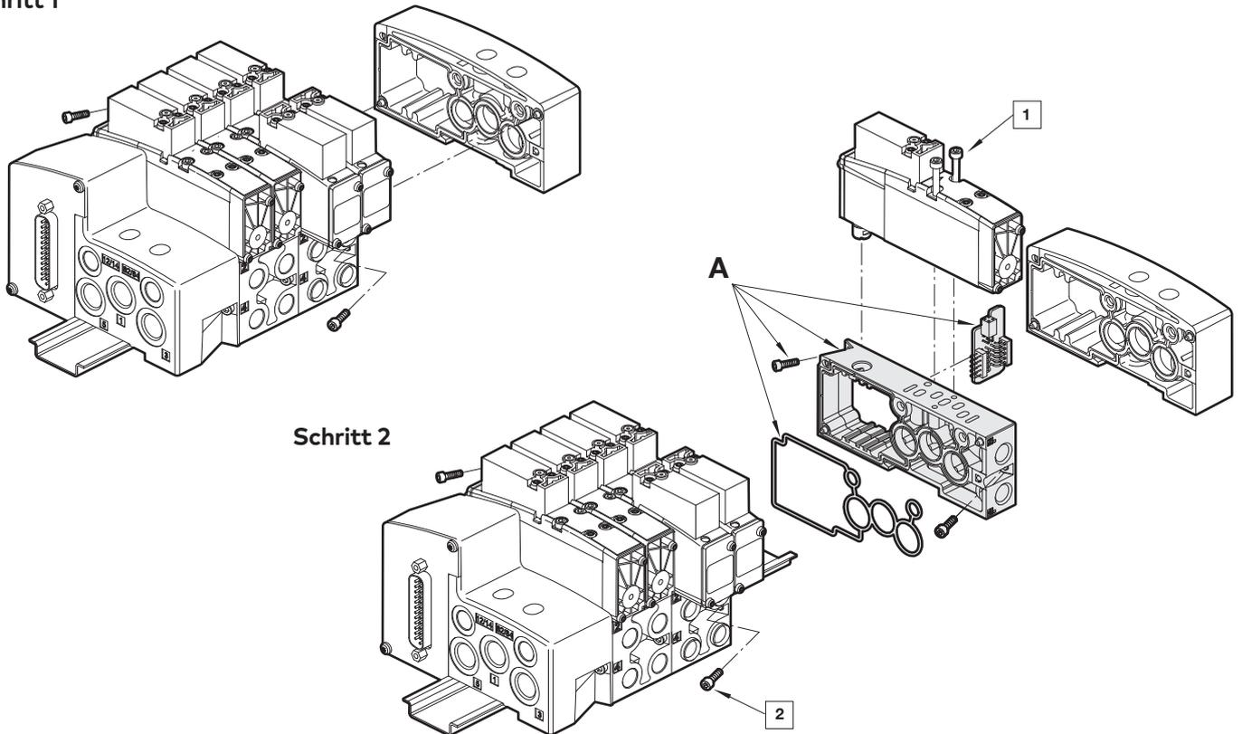
1 Anzugsdrehmoment = 0,8 ... 0,9 Nm Max. Drehzahl des Schraubers = max. 1100 U/min
