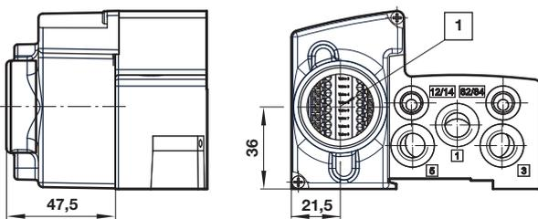
1 Max. Kabelabmessung AWG18
