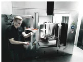
Die Prüfung des Werkzeugs auf Durchschlagsfestigkeit bei 10.000 Volt gibt dem Anwender die beruhigende Gewissheit, dass sein Schraubendreher auf seine wichtigste Eigenschaft, die Isolation, geprüft worden ist. Wera VDE-Schraubendreher werden Stück für Stück dieser Prüfung unterzogen. Sicheres Arbeiten bis 1.000 Volt ist somit garantiert.
