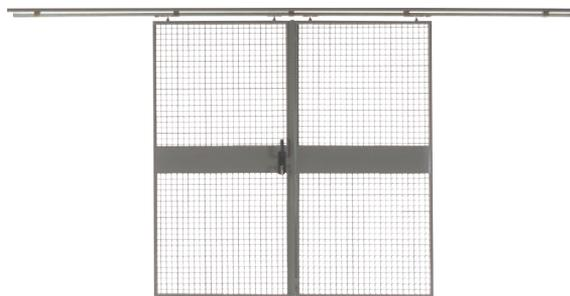
**Schiebetür** zweiflügelig mit Laufschiene, Bodenführungen und Anschlagpuffern, platzsparend beidseitig öffnend, Türflügel innen laufend (auch mit lichter Höhe 2500 mm für Staplerverkehr lieferbar).
