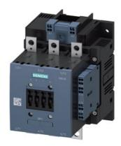
Leistungsschütz, AC-3e/AC-3 150 A, 75 kW / 400 V AC (50-60 Hz) / DC Uc: 575-600 V 3-polig, Hilfskontakte 2 S + 2  $\rm \ddot{O}$  Antrieb: konventionell Hauptstr.: Schiene Steuer- und Hilfsstromkreis: Federzuganschluss
