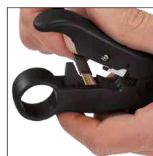
Abisolieren von Flachbandkabel Stripping of flat cables
