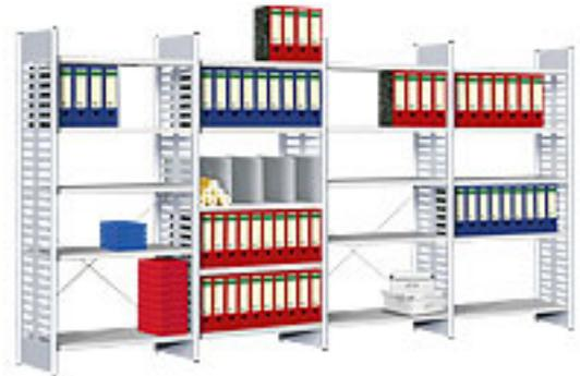
Seitenblechen und sind pulverbeschichtet in Alusilber (ähnlich RAL 9006). Eckfeld auch mit anderen Höhen erhältlich: 2200 mm und 2600 mm. Fachlast: Tragkraft pro Boden: 120 kg, mit Unterzügen bis 200 kg Feldlast (Tragkraft pro Regalfeld): 1000 kg Breite pro Regal = Nennbreite + 40 mm Eckfeld 400 + Tiefe 1 Seitenrahmen 4 Eckböden 1 Eckpfosten
