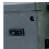
Auf der Rückseite des Handgriffs befindet sich der Umschaltknopf der zwei Geschwindigkeiten 180 und 500 1/min. 180 1/min = reinigen 500 1/min = polieren
