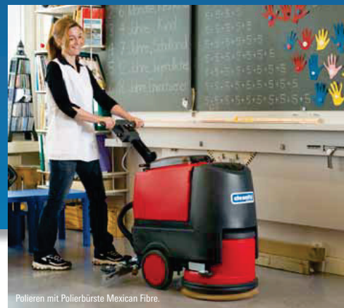
Polieren mit Polierbürste Mexican Fibre.
