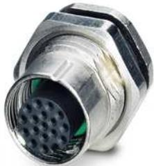
Sensor-/Aktor-Einbausteckverbinder, Buchse, 17-polig, M12-SPEEDCON, A-kodiert, Hinterwand-/Schraubmontage mit Pg9 Gewinde, mit geraden Lötstiften
