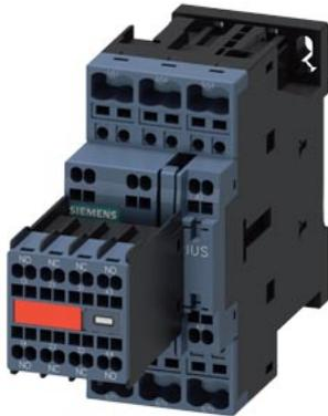
Leistungsschütz, AC-3e/AC-3, 38 A, 18,5 kW / 400 V, 3-polig, AC 230 V, 50/60 Hz, mit eingestecktem Varistor, Hilfskontakte: 2 S + 2 Ö, Federzuganschluss, Baugröße: S0, Hilfsschalter unlösbar
