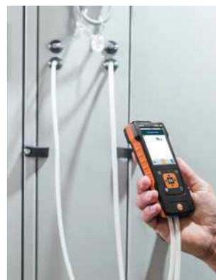
Mit dem Modell testo 440 dP inkl. Differenzdruck-Sensor stellen Sie sicher, dass die Filter von Klimaanlage ordnungsgemäß funktionieren und kein Schmutz der Außenluft in die Raumluft gelangt.
