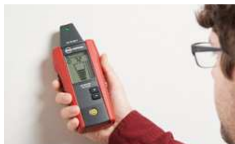
Suche nach spannungsführenden und spannungsfreien Leitungen
