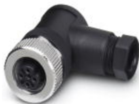
Sensor-/Aktor-Stecker, Buchse, gewinkelt, 5-polig, M12, A-codiert, Schraubanschluss, Metallrändel, Kabelverschraubung Pg7
