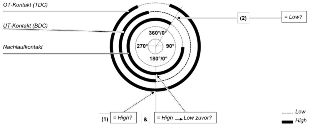
Abb. 141: Kontaktüberwachung mit dem Funktionsblock Kontaktmonitor Universalpresse mit aktiviertem UT-Kontakt (BDC) und Nachlauf
