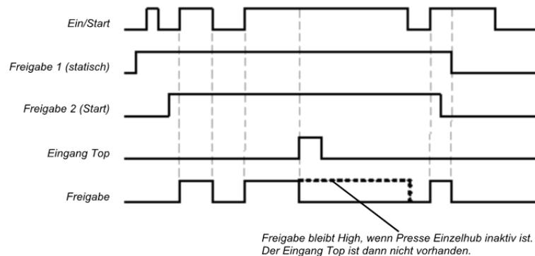
Abb. 145: Ablauf-/ Timingdiagramm für den Funktionsblock Presse Einrichten
