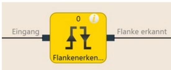
Abb. 63: Logische Anschlüsse für den Funktionsblock Flankenerkennung
