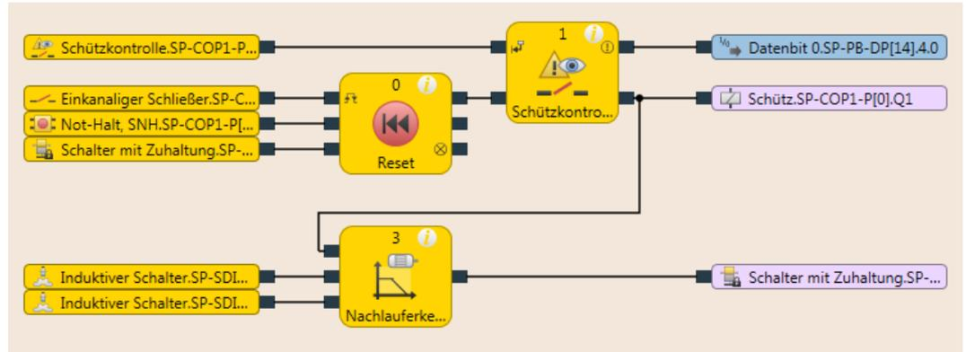
Abb. 98: Logikbeispiel für den Funktionsblock 'Nachlauferkennung'
