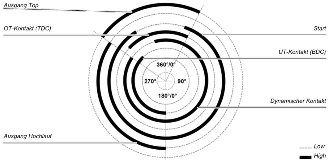
Abb. 133: Kontakt- und Ausgangsfolge einer Exzenterpresse bei einem fehlerfreien Ablauf (Beispiel)
