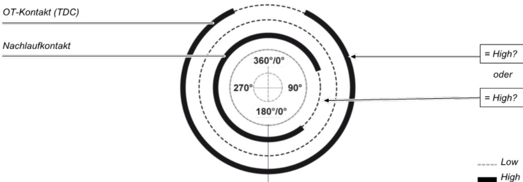
Abb. 135: Kontaktüberwachung mit dem Funktionsblock Kontaktmonitor Universalpresse mit aktiviertem Nachlauf
