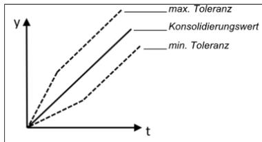
Abb. 182: Toleranz angegeben sowohl als absoluter Wert als auch als relativer Wert (Prozent), wobei die beiden Toleranzarten logisch UND verknüpft sind.
