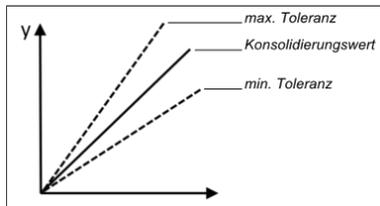
Abb. 181: Toleranz angegeben als relativer Wert (Prozent), z. B.  $\pm 10\%$
