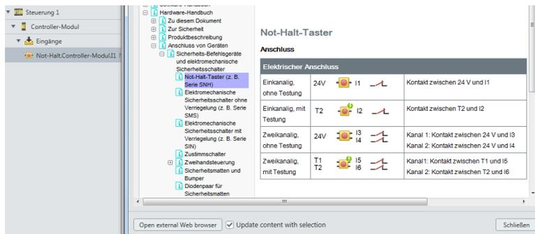
Abb. 10: Programmhilfe zum gewählten Objekt "Not-Halt-Taster"
