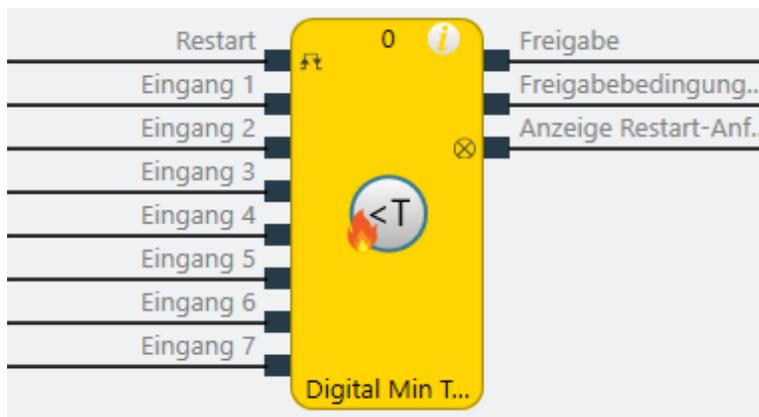
Abb. 215: Logische Anschlüsse für den Funktionsblock Digital Min Temperatur
