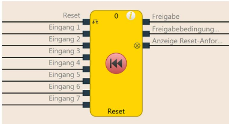
Abb. 74: Funktionsblockdiagramm für den Funktionsblock Reset
