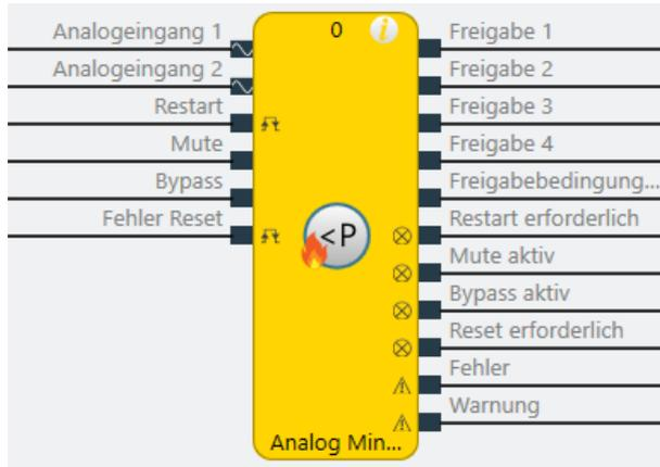
Abb. 184: Logische Anschlüsse für den Funktionsblock Analog Min Druck
