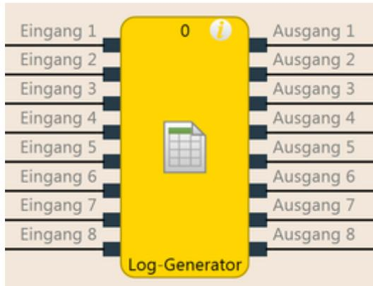
Abb. 68: Funktionsblockdiagramm für den Funktionsblock Log-Generator
