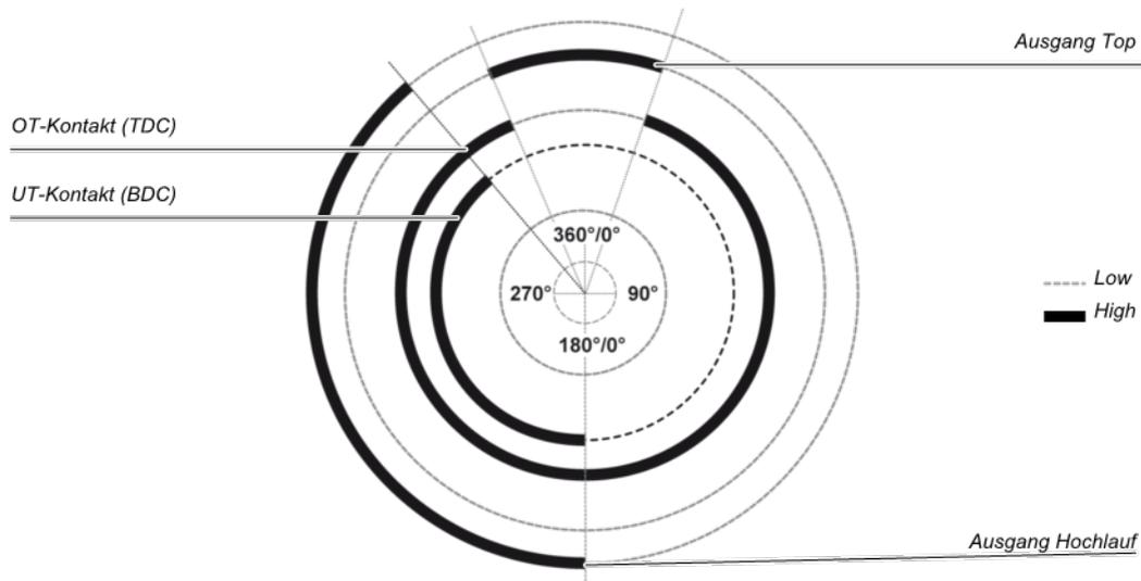
Abb. 138: Pressenzyklus für den Funktionsblock Kontaktmonitor Universalpresse mit fallender Flanke von UT-Kontakt (BDC) vor OT-Kontakt (TDC)
