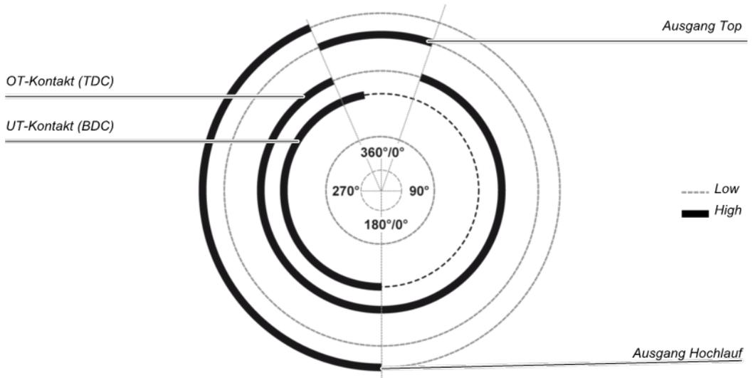
Abb. 137: Pressenzyklus für den Funktionsblock Kontaktmonitor Universalpresse mit fallender Flanke von **OT-Kontakt (TDC)** vor **UT-Kontakt (BDC)**
