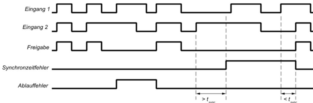
Abb. 102: Ablauf-/Timingdiagramm für den Funktionsblock Not-Halt
