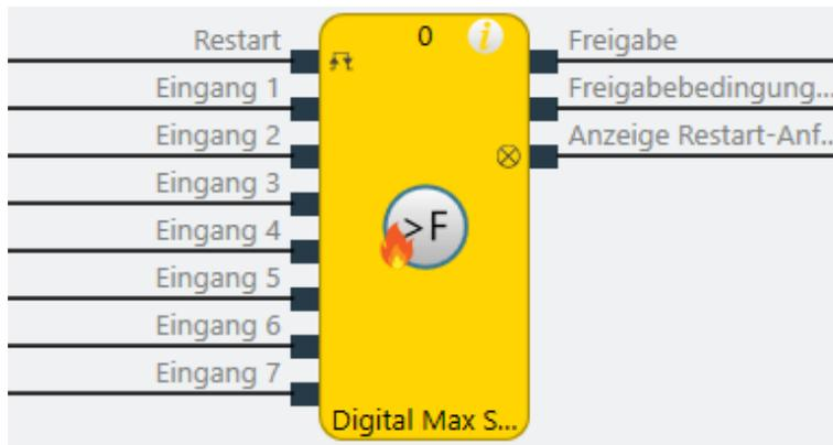
Abb. 213: Logische Anschlüsse für den Funktionsblock Digital Max Strömung
