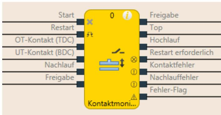
Abb. 134: Logische Anschlüsse für den Funktionsblock Kontaktmonitor Universalpresse
