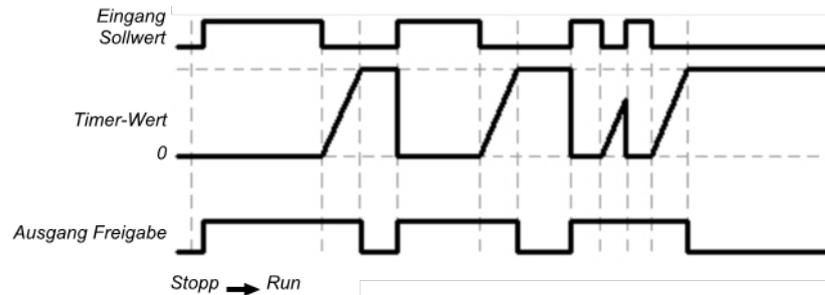
Abb. 79: Ablauf-/Timingdiagramm für den Funktionsblock Abschaltverzögerung
