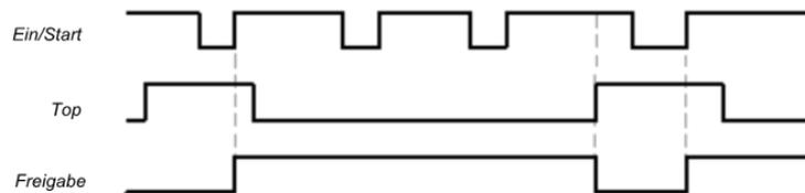
Abb. 150: Ablauf-/ Timingdiagramm für den Funktionsblock Presse Einzelhub bei Konfiguration von Ein/Start auf 2 - Einmalig Start
