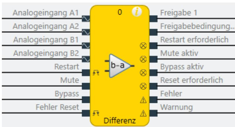
Abb. 175: Logische Anschlüsse für den Funktionsblock Differenz
