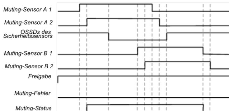
Abb. 121: Gültige Muting-Sequenz bei Benutzung der Konfigurations-Grundeinstellung
