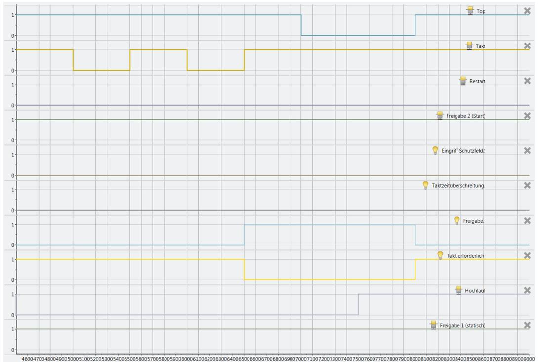
Abb. 154: Ablauf-/ Timingdiagramm für eine vollständige Sequenz im Standard-Mode mit 2 parametrisierten Eingriffen ohne Wiederanlaufsperr
