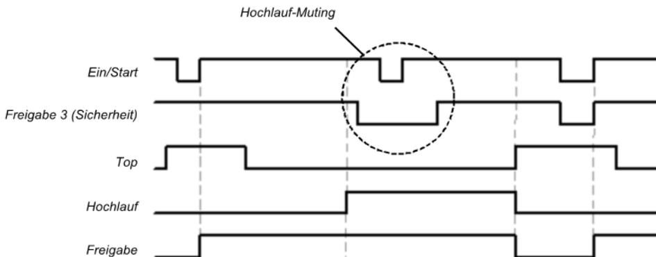
Abb. 148: Ablauf-/ Timingdiagramm für den Funktionsblock Presse Einzelhub Hochlauf-Muting von Ein/Start und Freigabe 3 (Sicherheit)
