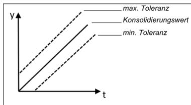
Abb. 165: Toleranz angegeben als absoluter Wert in der gewählten Einheit, z. B.  $\pm 10^\circ\text{C}$
