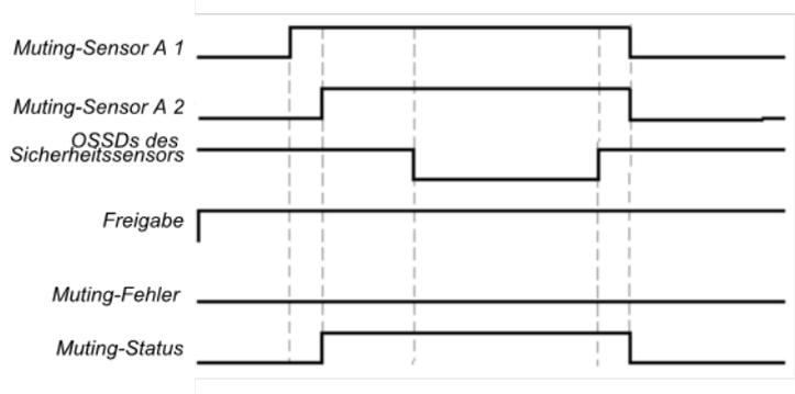
Abb. 124: Gültige Muting-Sequenz bei Benutzung der Konfigurations-Grundeinstellung
