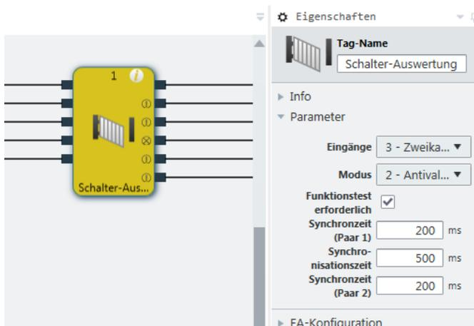
Abb. 41: Konfigurierbare Parameter von Funktionsblöcken
