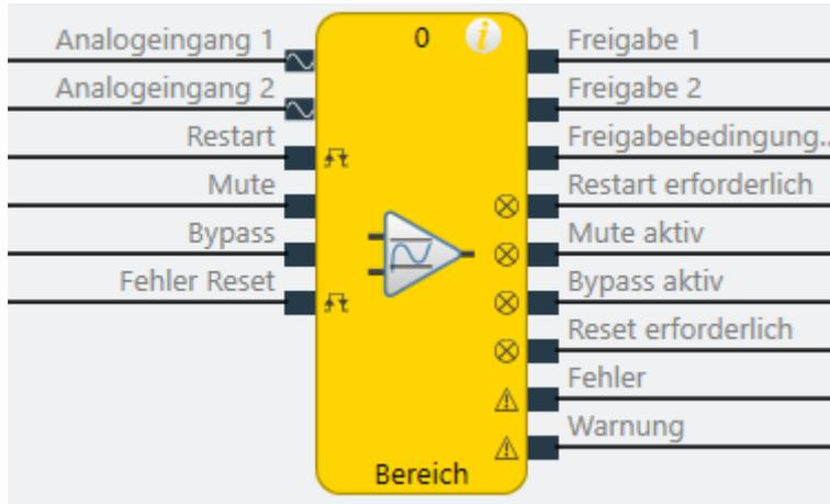
Abb. 172: Logische Anschlüsse für den Funktionsblock Bereich
