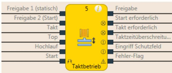
Abb. 153: Logische Anschlüsse für den Funktionsblock Taktbetrieb
