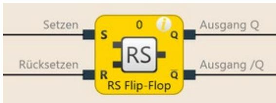
Abb. 49: Logische Anschlüsse für den Funktionsblock RS Flip-Flop
