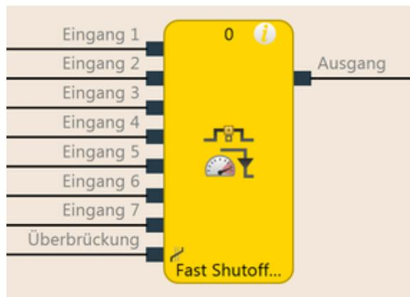
Abb. 56: Logische Anschlüsse für den Funktionsblock Fast Shut Off mit Bypass
