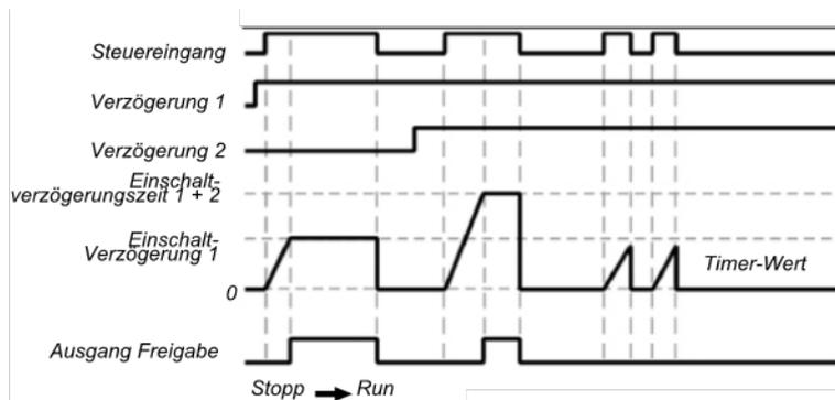
Abb. 85: Ablauf-/Timingdiagramm für den Funktionsblock Einstellbare Einschaltverzögerung mit Einschaltverzögerungszeit 1 und Einschaltverzögerungszeit 2
