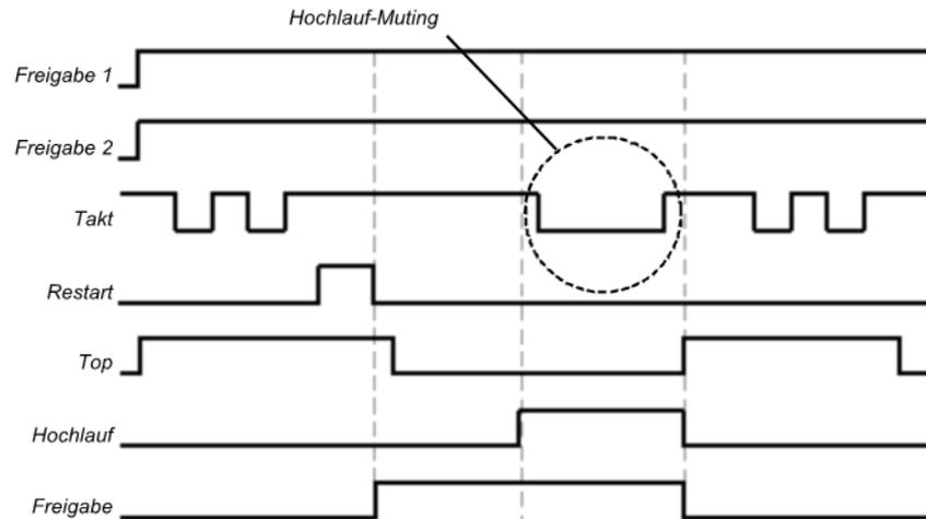
Abb. 157: Ablauf-/ Timingdiagramm für Hochlauf-Muting im Standard-Modus im Zweitaktbetrieb
