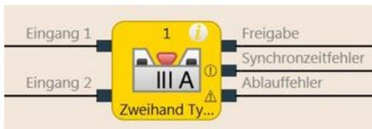
Abb. 108: Funktionsblockdiagramm für den Funktionsblock Zweihand Typ IIIA
