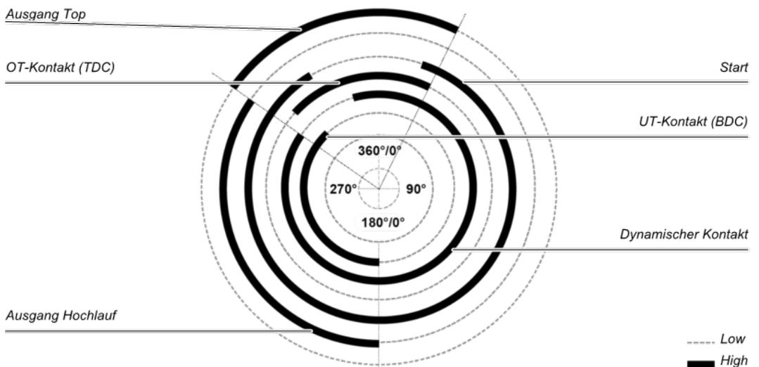
Abb. 142: Kontakt- und Ausgangsfolge einer Universalpresse bei einem fehlerfreien Ablauf (Beispiel)
