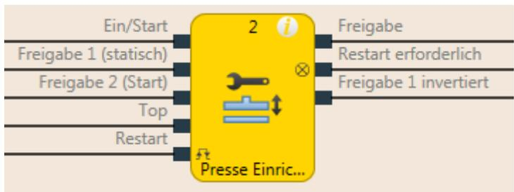
Abb. 143: Logische Anschlüsse für den Funktionsblock Presse Einrichten
