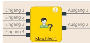
Abb. 33: Logische Anschlüsse für den benutzerdefinierten Funktionsblock
