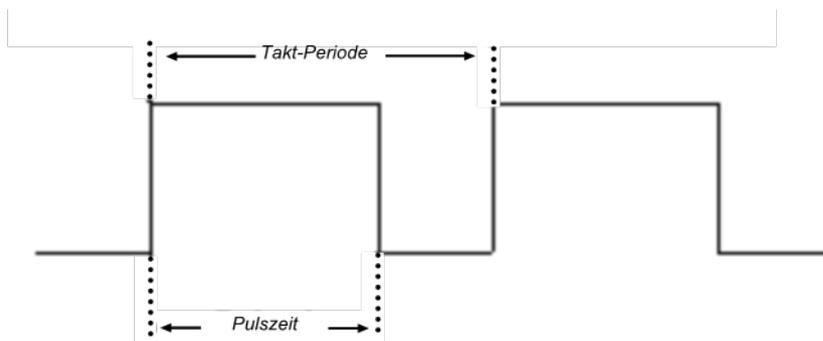
Abb. 52: Parameterdiagramm für den Funktionsblock „Taktgenerator“
