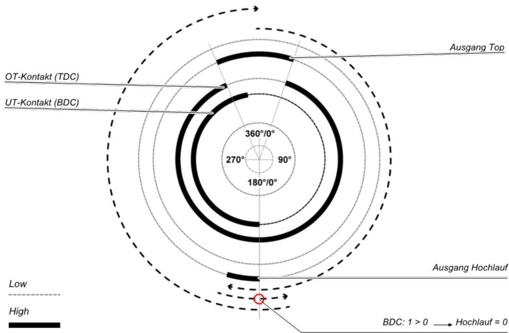
Abb. 139: Pressenzyklus für den Funktionsblock Kontaktmonitor Universalpresse mit 2 BDC-Übergängen
