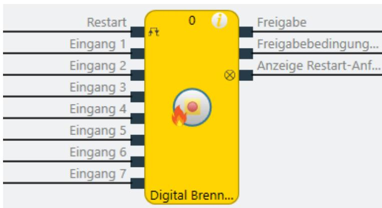
Abb. 223: Logische Anschlüsse für den Funktionsblock Digital Brennstoff Aus
