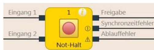
Abb. 101: Funktionsblockdiagramm für den Funktionsblock Not-Halt
