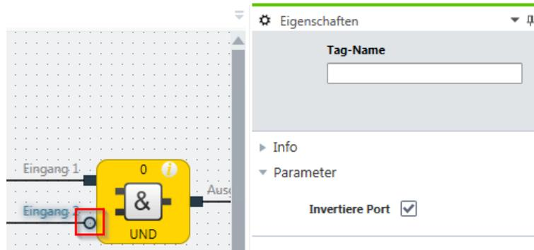
Abb. 42: Beispiel eines UND-Funktionsblocks mit einem invertierten Eingang
