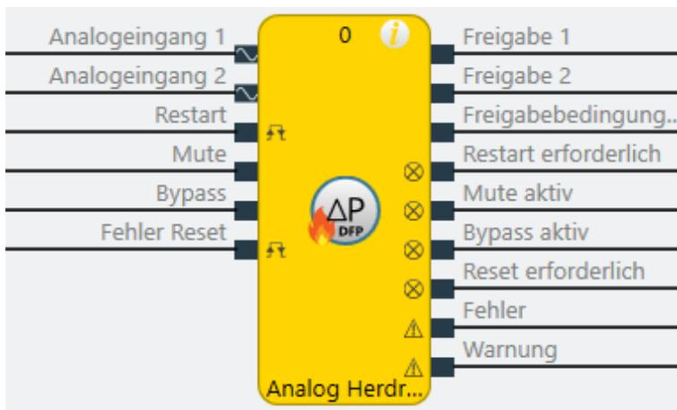
Abb. 204: Logische Anschlüsse für den Funktionsblock Analog Herdraumdruck
