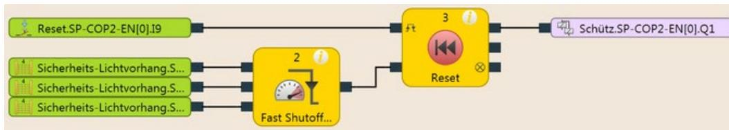
Abb. 57: Konfigurationsbeispiel für Fast Shut Off mit drei Lichtvorhängen
