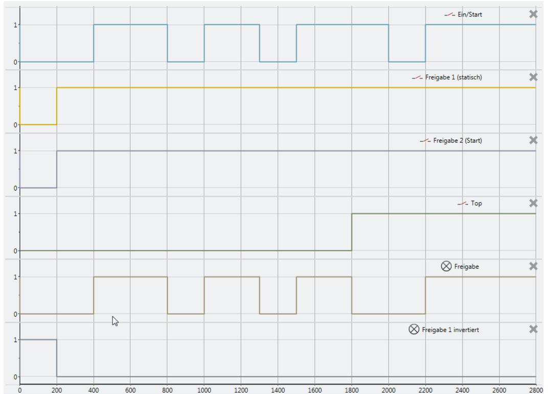
Abb. 144: Typisches Ablauf-/Timingdiagramm für den Funktionsblock Presse Einrichten
