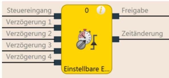
Abb. 84: Funktionsblockdiagramm für den Funktionsblock Einstellbare Einschaltverzögerung
