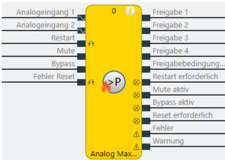
Abb. 187: Logische Anschlüsse für den Funktionsblock Analog Max Druck
