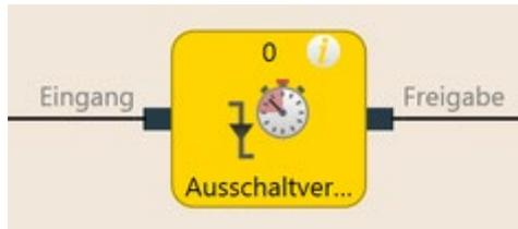
Abb. 78: Funktionsblockdiagramm für den Funktionsblock Abschaltverzögerung
