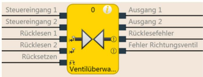
Abb. 88: Logische Anschlüsse für den Funktionsblock Ventilüberwachung, konfiguriert für ein Richtungsventil
