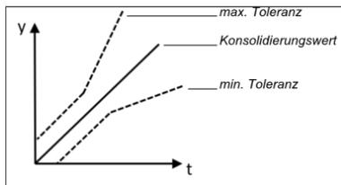
Abb. 183: Toleranz angegeben sowohl als absoluter Wert als auch als relativer Wert (Prozent), wobei die beiden Toleranzarten logisch ODER verknüpft sind.
