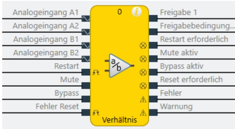
Abb. 174: Logische Anschlüsse für den Funktionsblock Verhältnis
