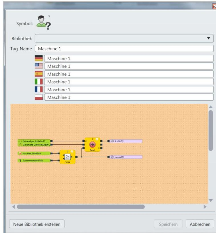
Abb. 34: Dialog Funktionsblockdetails editieren für den benutzerdefinierten Funktionsblock
