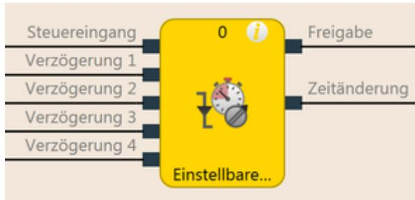
Abb. 80: Funktionsblockdiagramm für den Funktionsblock Einstellbare Abschaltverzögerung
