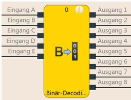
Abb. 66: Logische Anschlüsse für den Funktionsblock Binär-Decodierer
