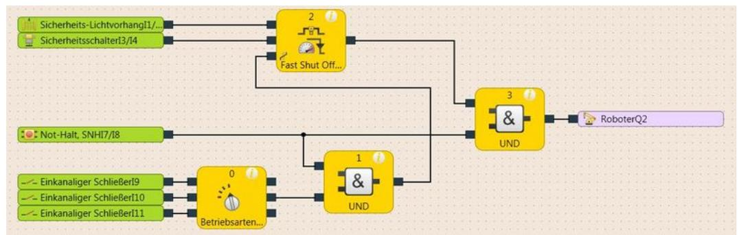
Abb. 62: Beispiel für Fast Shut Off mit Bypass mit mehr als einer Bedingung für Bypass
