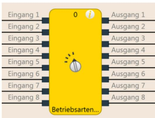
Abb. 92: Funktionsblockdiagramm für den Funktionsblock Betriebsartenwahlschalter
