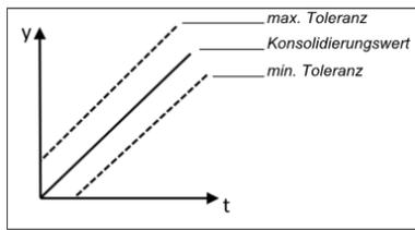
Abb. 180: Toleranz angegeben als absoluter Wert in der gewählten Einheit, z. B.  $\pm 10^\circ\text{C}$
