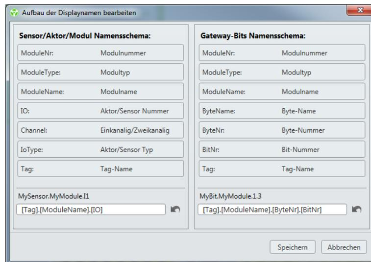
Abb. 13: Dialogfenster für die Konfiguration der Displaynamen
