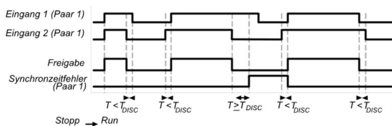
Abb. 107: Ablauf-/Timingdiagramm für Funktionsblock Schalter-Auswertung, Kategorie 4, zweikanalig ohne Funktionstest
