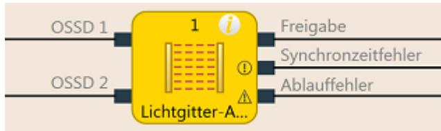
Abb. 104: Funktionsblockdiagramm für den Funktionsblock Lichtgitter-Auswertung
