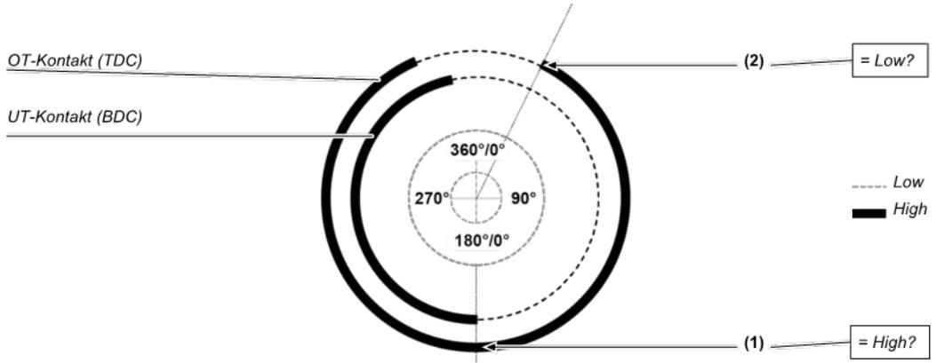
Abb. 136: Kontaktüberwachung mit dem Funktionsblock Kontaktmonitor Universalpresse mit aktiviertem **UT-Kontakt (BDC)**
