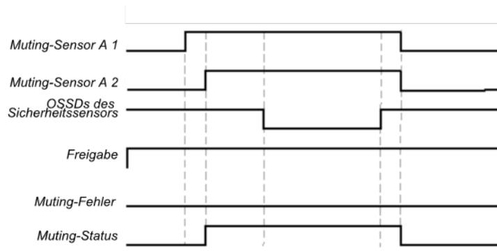
Abb. 127: Gültige Muting-Sequenz bei Benutzung der Konfigurations-Grundeinstellung
