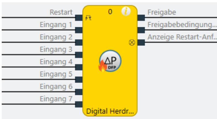
Abb. 221: Logische Anschlüsse für den Funktionsblock Herdraumdruck
