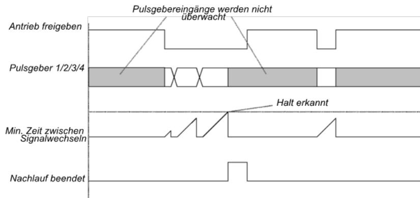
Abb. 99: Ablauf-/Timingdiagramm für den Funktionsblock 'Nachlauferkennung'
