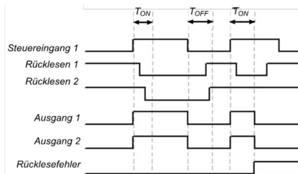
Abb. 90: Ablauf-/Timingdiagramm für Doppelventil im manuellen Resetmodus
