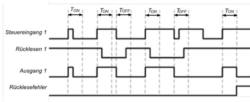
Abb. 89: Ablauf-/Timingdiagramm für Einzelventil im manuellen Resetmodus
