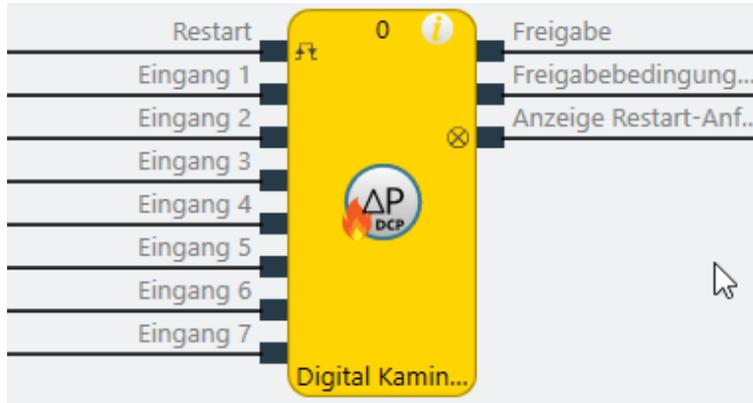
Abb. 219: Logische Anschlüsse für den Funktionsblock Digital Kaminzug
