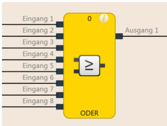
Abb. 46: Funktionsblockdiagramm für den Funktionsblock ODER
