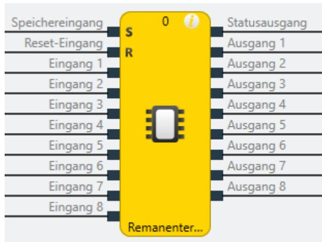
Abb. 73: Funktionsblockdiagramm für den Funktionsblock Remanenter Speicher
