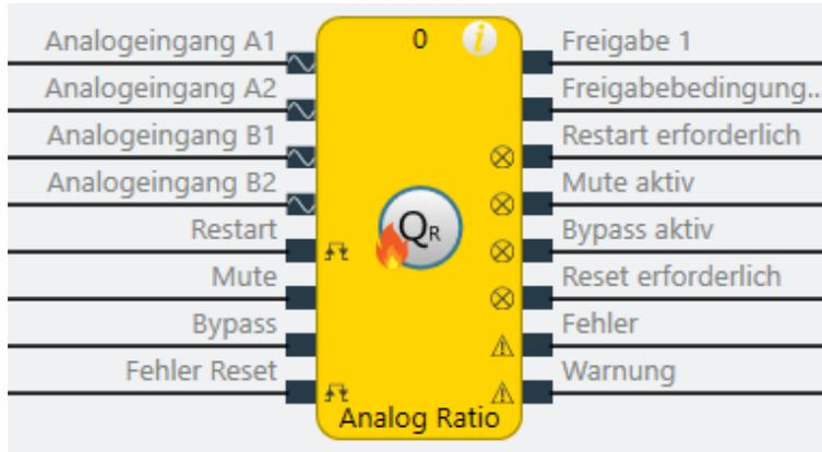
Abb. 206: Logische Anschlüsse für den Funktionsblock Analog Ratio
