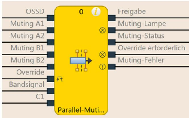
Abb. 116: Logische Anschlüsse für den Funktionsblock Parallel-Muting
