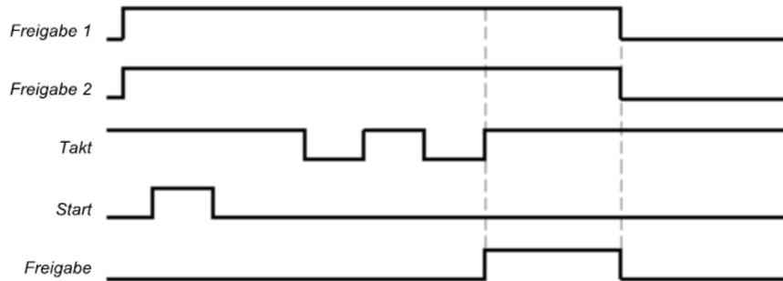
Abb. 156: Ablauf-/ Timingdiagramm für eine vollständige Startsequenz im Schweden-Modus im Zweitaktbetrieb
