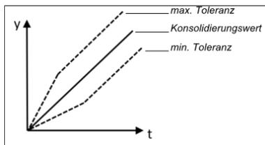
Abb. 167: Toleranz angegeben sowohl als absoluter Wert als auch als relativer Wert (Prozent), wobei die beiden Toleranzarten logisch UND verknüpft sind.
