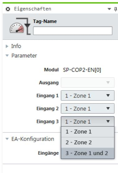
Abb. 59: Parametereinstellungen für den Funktionsblock Fast Shut Off
