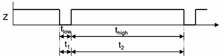
Abb. 97: Signalmuster für einzelnes Pulsgebersignal
