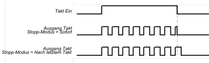
Abb. 53: Timingdiagramm für den Funktionsblock Taktgenerator
