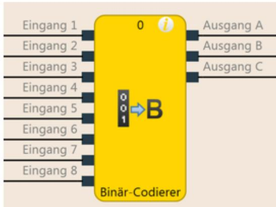
Abb. 65: Logische Anschlüsse für den Funktionsblock Binär-Codierer
