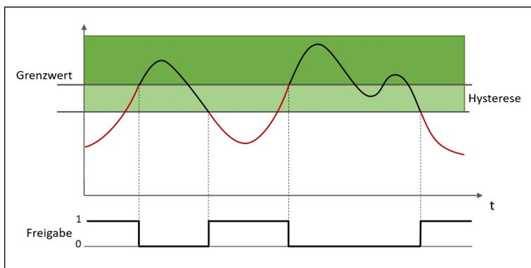
Abb. 201: Überwachung auf "Unterschreitung"
