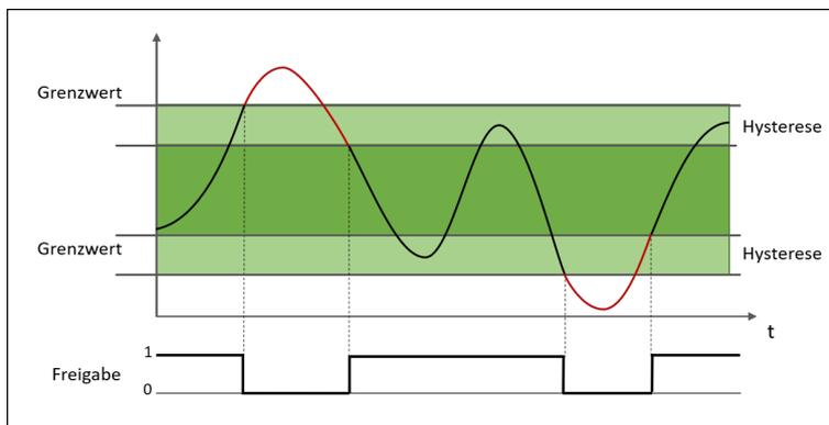
Abb. 203: Überwachung auf „Innerhalb eines Bereiches“
