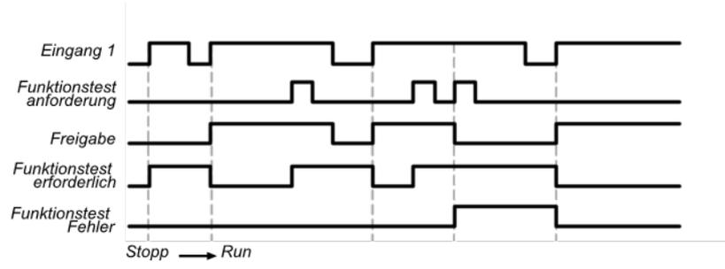
Abb. 106: Ablauf-/Timingdiagramm für Funktionsblock Schalter-Auswertung, Kategorie 2, einkanalig mit Funktionstest
