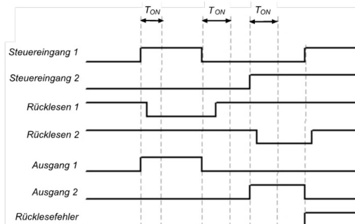
Abb. 91: Ablauf-/Timingdiagramm für Richtungsventil
