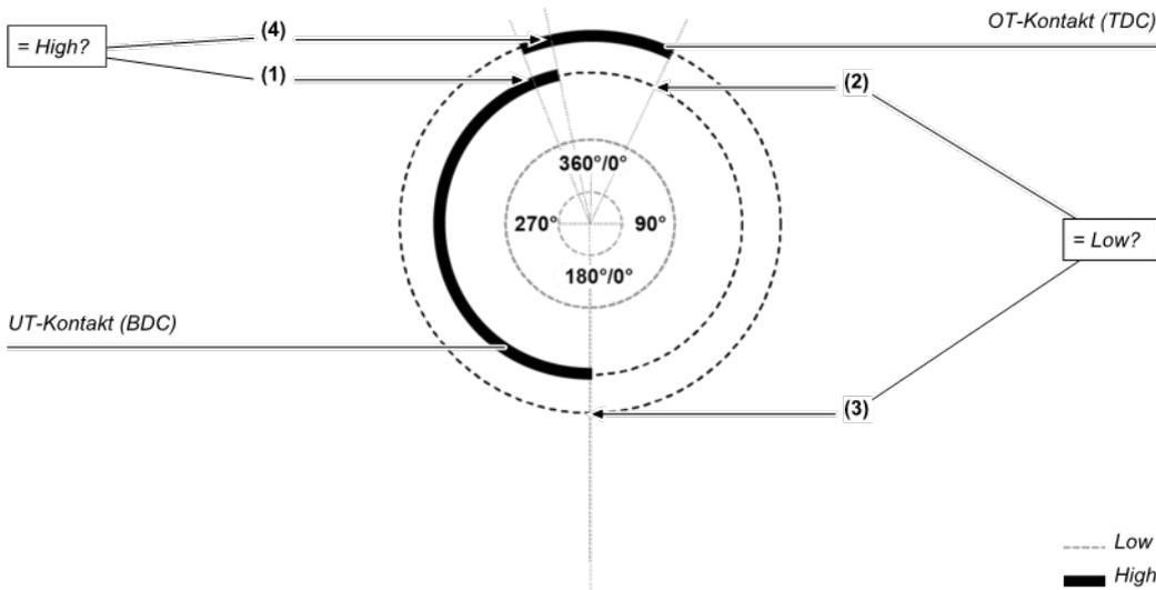
Abb. 129: Kontaktüberwachung mit dem Funktionsblock Kontaktmonitor Exzenterpresse
