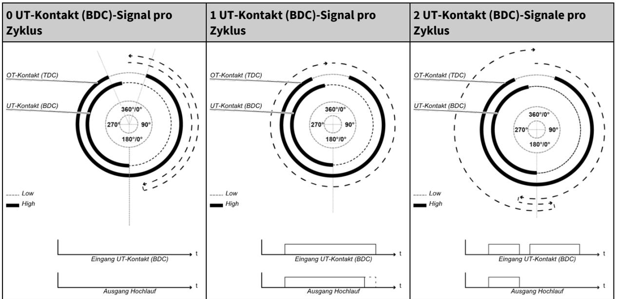
Der Eingang **UT-Kontakt (BDC)** kann mit dem Eingang **Nachlauf** kombiniert werden. In diesem Fall gelten die Vorgänge, die im Abschnitt **Eingänge UT-Kontakt (BDC) und Nachlauf** beschrieben sind.
