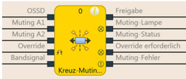
Abb. 125: Logische Anschlüsse für den Funktionsblock Kreuz-Muting (zweiseitig)
