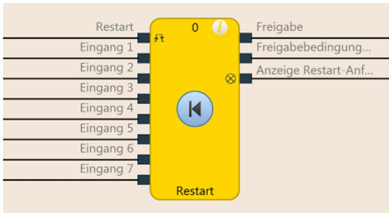
Abb. 76: Funktionsblockdiagramm für den Funktionsblock Restart
