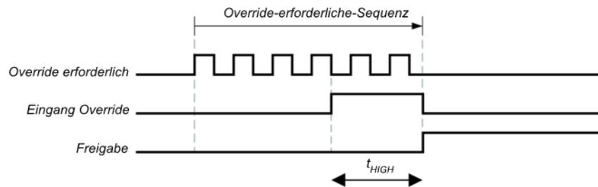
Abb. 115: Logikdiagramm für Override und Override-Anforderung]
