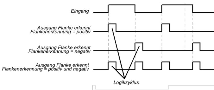
Abb. 64: Timingdiagramm für den Funktionsblock Flankenerkennung
