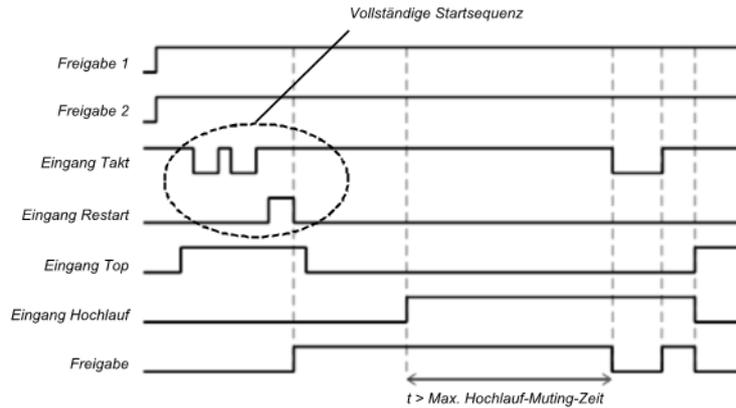
Abb. 160: Ablauf-/ Timingdiagramm, wenn der Eingang Takt Low, maximale Hochlauf-Muting-Zeit > 0 und Wiederanlaufsperrung auf 3 - Nach Stillstand im Abwärtshub oder Ausgangsstellung gesetzt ist.
