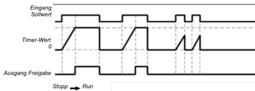
Abb. 83: Ablauf-/Timingdiagramm für den Funktionsblock Einschaltverzögerung
