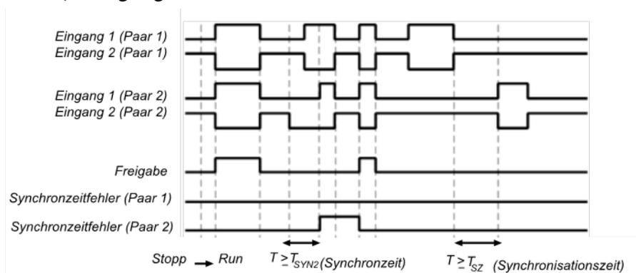
Abb. 110: Ablauf-/Timingdiagramm für den Funktionsblock Zweihand Typ IIIC
