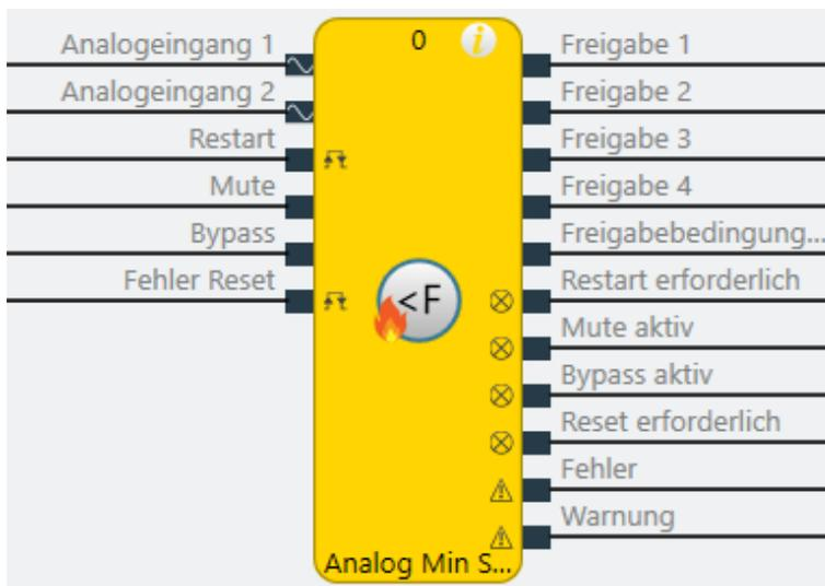
Abb. 190: Logische Anschlüsse für den Funktionsblock Analog Min Strömung
