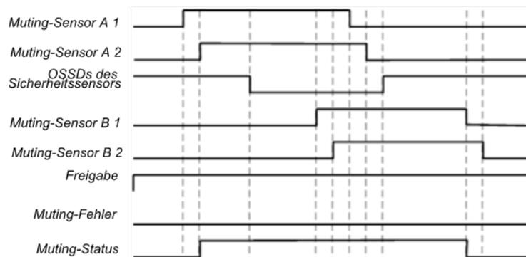
Abb. 118: Gültige Muting-Sequenz bei Benutzung der Konfigurations-Grundeinstellung
