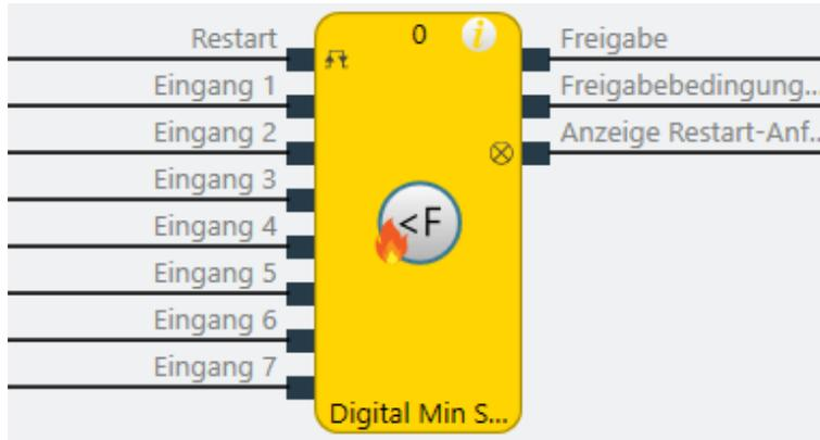
Abb. 211: Logische Anschlüsse für den Funktionsblock Digital Min Strömung
