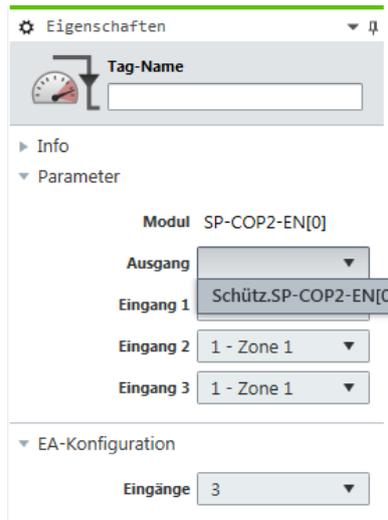
Abb. 60: Ausgang für Fast Shut Off anwählen
