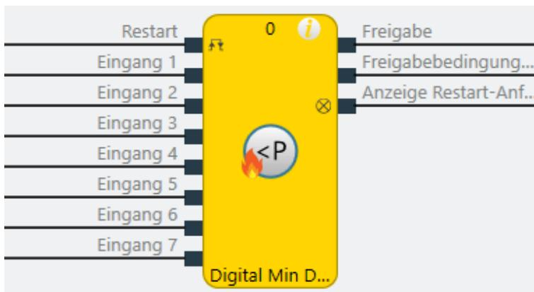
Abb. 207: Logische Anschlüsse für den Funktionsblock Digital Min Druck
