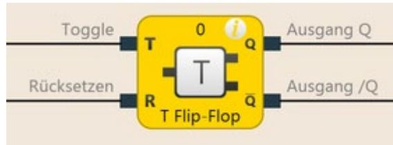
Abb. 48: Funktionsblockdiagramm für den Funktionsblock T-Flip-Flop
