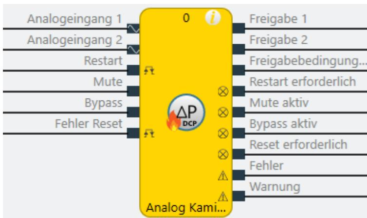
Abb. 202: Logische Anschlüsse für den Funktionsblock Analog Kaminzug
