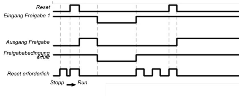
Abb. 77: Ablauf-/Timingdiagramm für den Funktionsblock Restart
