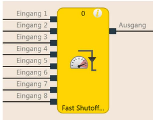
Abb. 55: Logische Anschlüsse für den Funktionsblock Fast Shut Off
