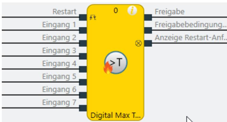
Abb. 217: Logische Anschlüsse für den Funktionsblock Digital Max Temperatur
