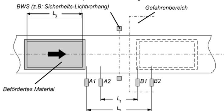
Abb. 120: Beispiel für die sequenzielle Anordnung von Muting-Sensoren
