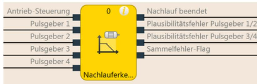
Abb. 94: Logische Anschlüsse für den Funktionsblock Nachlauferkennung
