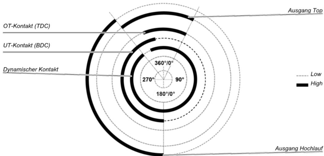
Abb. 131: Pressenzyklus für den Funktionsblock Kontaktmonitor Exzenterpresse mit Dynamischer Kontakt beim Aufwärtshub
