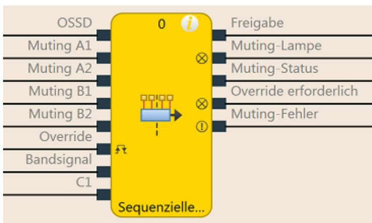
Abb. 119: Logische Anschlüsse für den Funktionsblock Sequenzielles Muting
