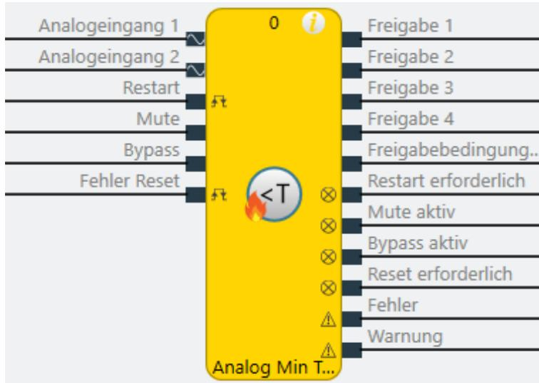
Abb. 196: Logische Anschlüsse für den Funktionsblock Analog Min Temperatur
