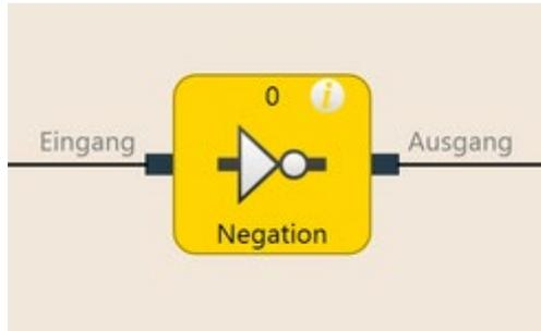
Abb. 44: Funktionsblockdiagramm für den Funktionsblock NOT
