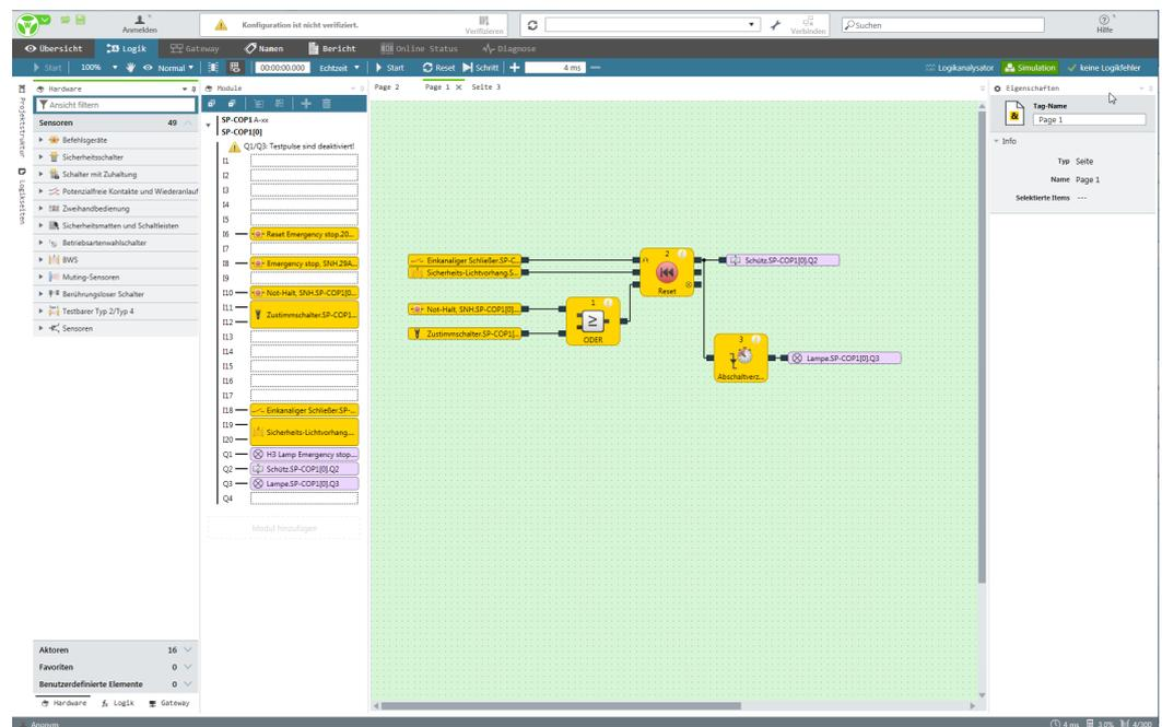
Abb. 37: Simulation einer gültigen Logik-Konfiguration
