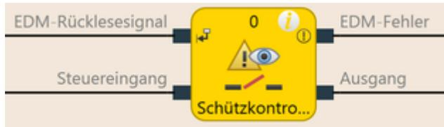
Abb. 86: Funktionsblockdiagramm für den Funktionsblock EDM
