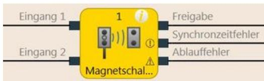
Abb. 103: Logische Anschlüsse für den Funktionsblock Magnetschalter
