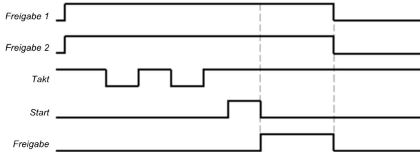
Abb. 155: Ablauf-/ Timingdiagramm für eine vollständige Startsequenz im Standard-Modus im Zweitaktbetrieb
