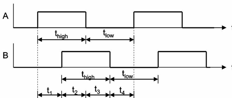
Abb. 95: Signalmuster für A/B-Pulsgeber mit 90° Phasenversatz
