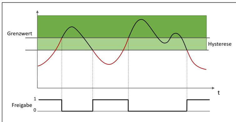
Abb. 186: Überwachung auf "Unterschreitung"
