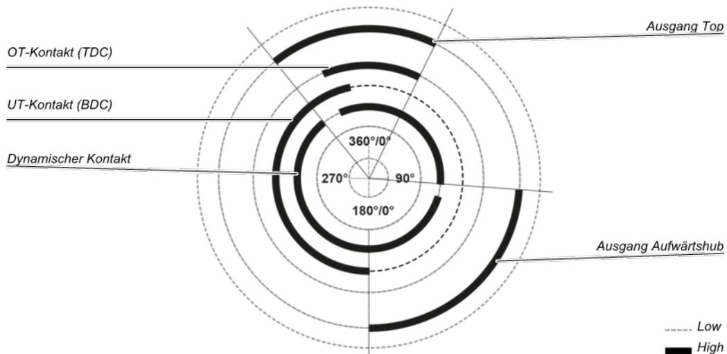
Abb. 132: Pressenzyklus für den Funktionsblock Kontaktmonitor Exzenterpresse mit Dynamischer Kontakt beim Hochlauf und bei der Abwärtsbewegung
