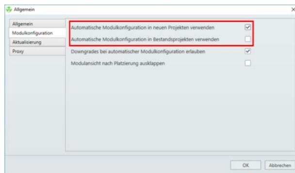
In diesem Fall aktiviert samosPLAN6 für neue Projekte grundsätzlich die automatische Modulkonfiguration. Wenn Sie ein bestehendes Projekt öffnen, schaltet samosPLAN6 automatisch auf manuelle Modulkonfiguration.
