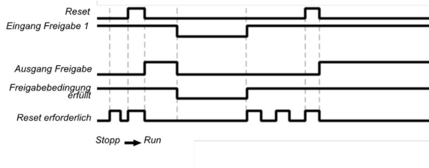
Abb. 75: Ablauf-/Timingdiagramm für den Funktionsblock Reset
