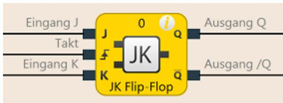
Abb. 50: Logische Anschlüsse für den Funktionsblock JK Flip-Flop
