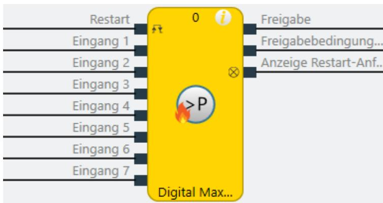
Abb. 209: Logische Anschlüsse für den Funktionsblock Digital Max Druck
