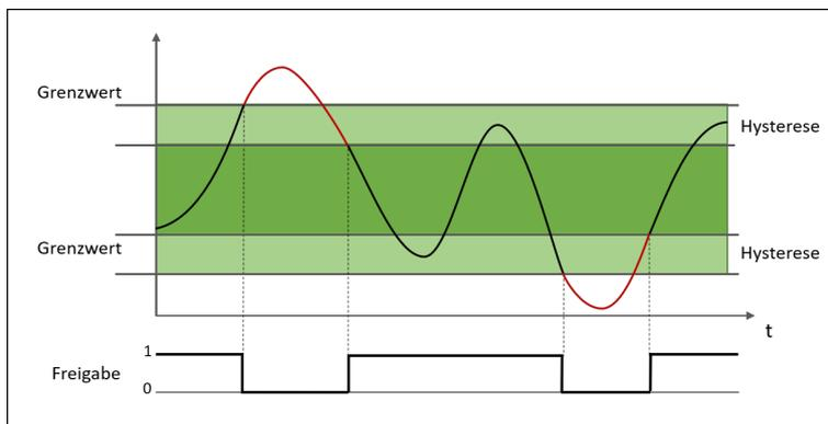
Abb. 205: Überwachung auf „Innerhalb eines Bereiches“
