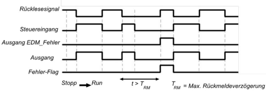
Abb. 87: Ablauf-/Timingdiagramm für den Funktionsblock EDM
