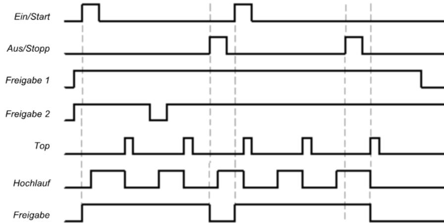
Abb. 152: Typisches Ablauf-/Timingdiagramm für den Funktionsblock Presse Automatik
