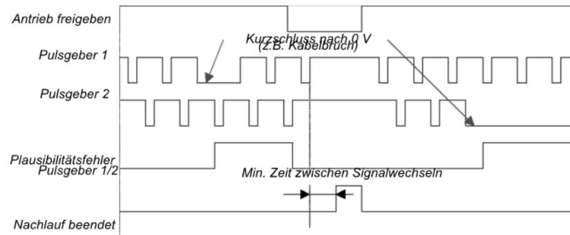
Abb. 100: Ablauf-/Timingdiagramm für den Funktionsblock 'Nachlauferkennung mit Plausibilitätsprüfung'
