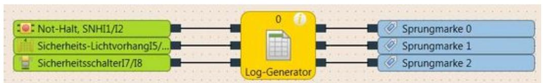
Abb. 69: Konfigurationsbeispiel für Log-Generator mit zwei Not-Halt-Tastern und einem Sicherheits-Schalter
