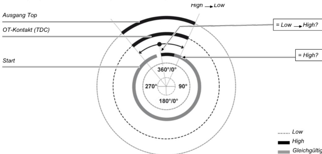
Abb. 130: Nachlaufüberwachung mit dem Funktionsblock Kontaktmonitor Exzenterpresse
