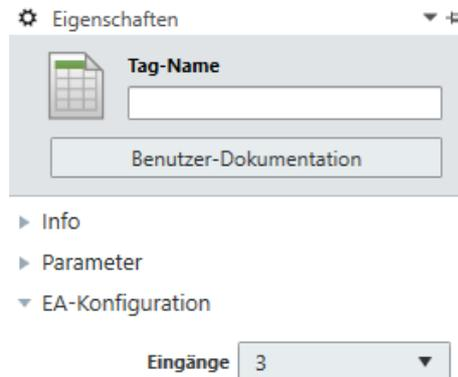
Abb. 70: E/A-Konfiguration für den Funktionsblock Log-Generator
