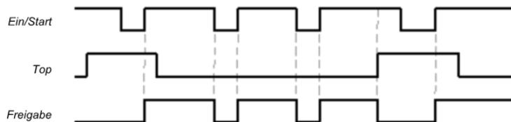
Abb. 149: Ablauf-/ Timingdiagramm für den Funktionsblock Presse Einzelhub bei Konfiguration von Ein/Start auf 1 - Tippen
