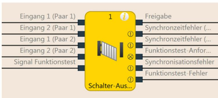
Abb. 105: Funktionsblockdiagramm für den Funktionsblock Schalter-Auswertung
