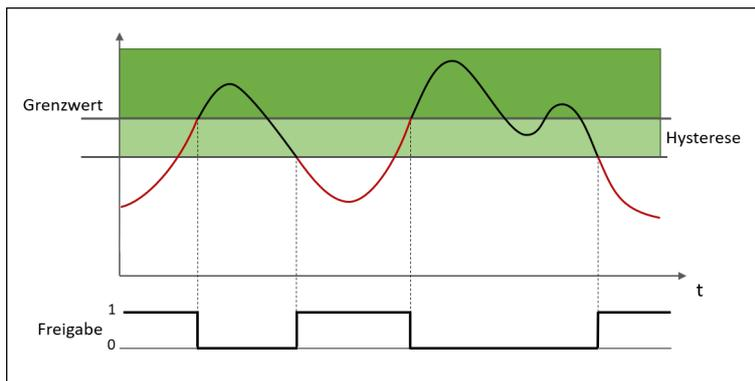
Abb. 195: Überwachung auf "Unterschreitung"
