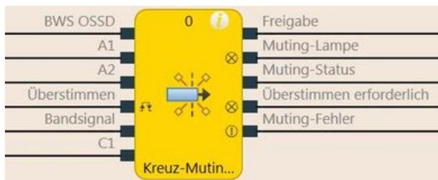
Abb. 122: Logische Anschlüsse für den Funktionsblock Kreuz-Muting (einseitig) mit dem Eingang C1
