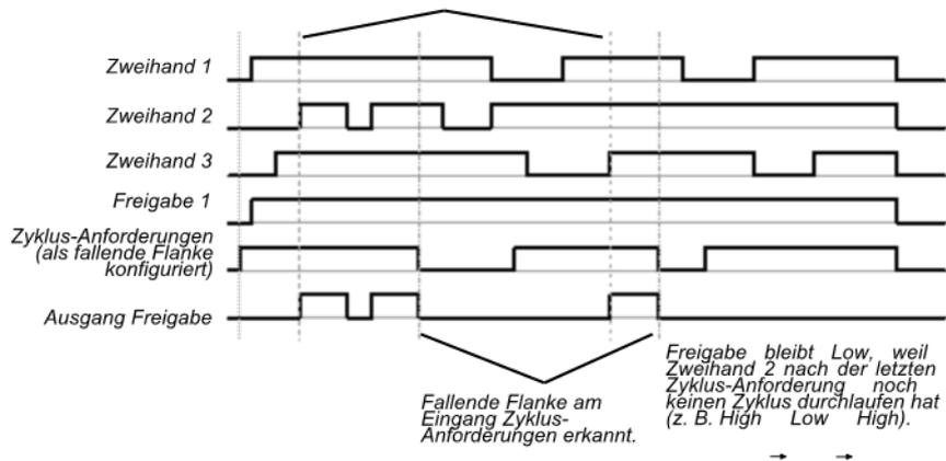
Abb. 112: Ablauf-/Timingdiagramm für den Funktionsblock Mehrfach-Zweihand
