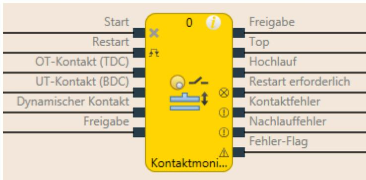
Abb. 128: Logische Anschlüsse für den Funktionsblock Kontaktmonitor Exzenterpresse
