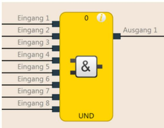
Abb. 45: Funktionsblockdiagramm für den Funktionsblock UND
