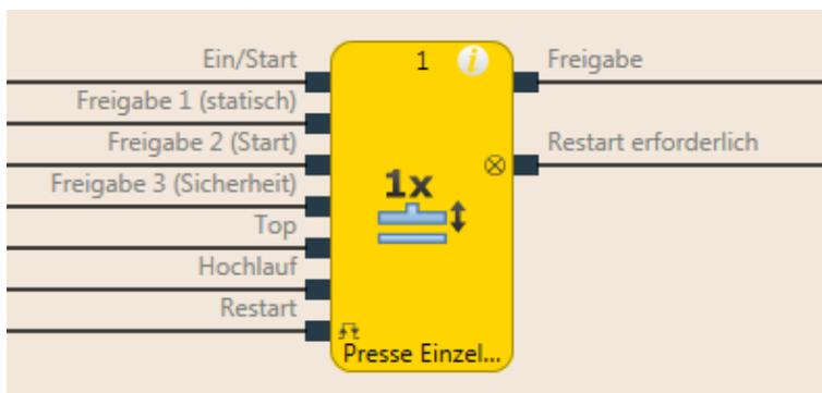
Abb. 146: Logische Anschlüsse für den Funktionsblock Presse Einzelhub
