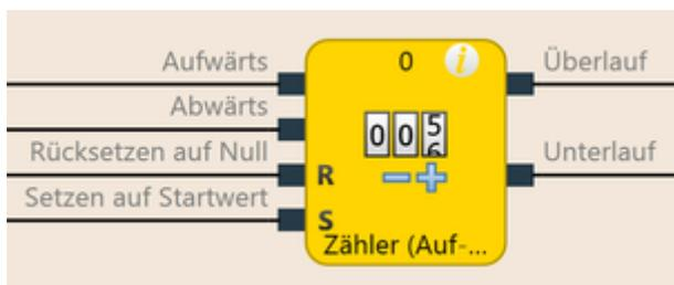
Abb. 54: Logische Anschlüsse für den Funktionsblock Zähler (Auf- und Abwärts)
