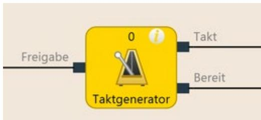
Abb. 51: Logische Anschlüsse für den Funktionsblock Taktgenerator
