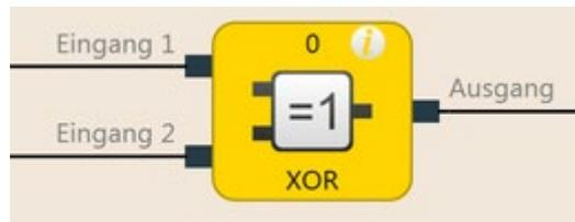
Abb. 47: Funktionsblockdiagramm für den Funktionsblock XOR (exklusives ODER)
