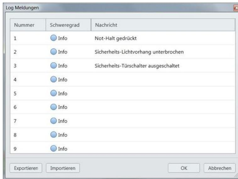
Abb. 71: Verfügbare Meldungen im Funktionsblock Log-Generator
