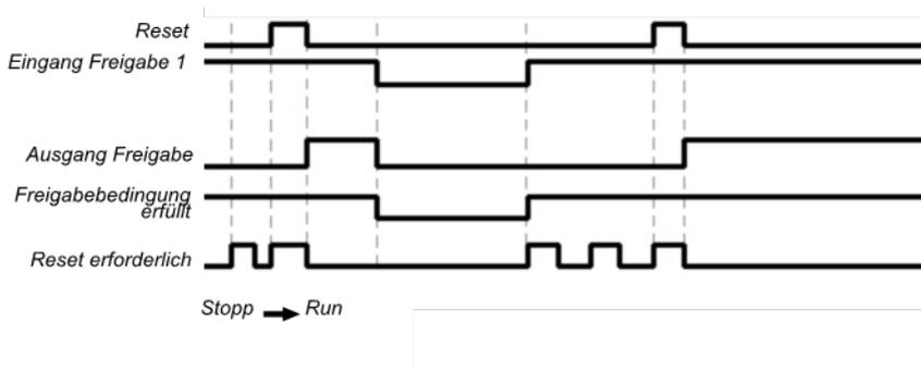
Abb. 216: Ablauf-/Timing-Diagramm für den Funktionsblock
