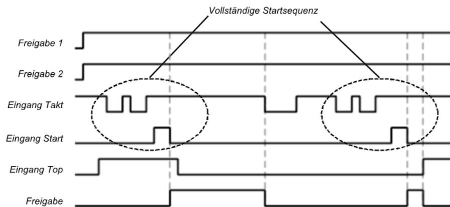
Abb. 159: Ablauf-/Timingdiagramm, wenn der Eingang Takt Low, Hochlauf-Muting inaktiv und Wiederanlaufsperr auf 2 - immer gesetzt ist.
