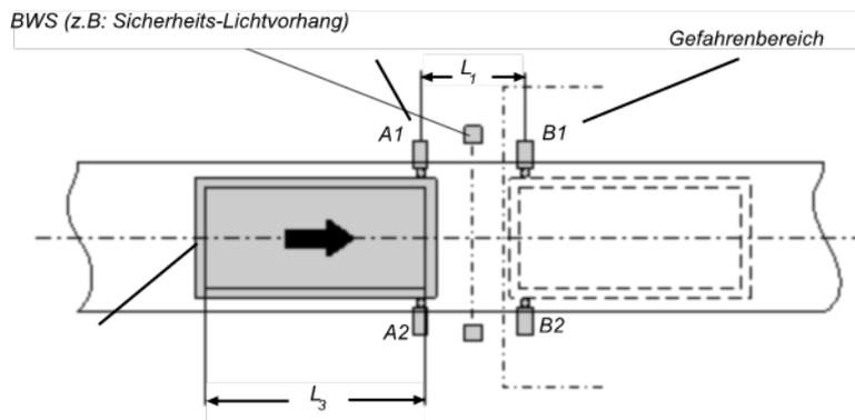
Abb. 117: Muting mit zwei parallelen Sensorpaaren
