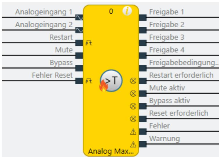
Abb. 199: Logische Anschlüsse für den Funktionsblock Analog Max Temperatur
