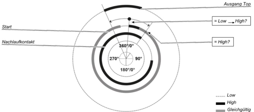
Abb. 140: Nachlaufüberwachung mit dem Funktionsblock Kontaktmonitor Universalpresse
