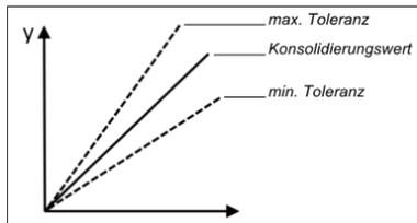
Abb. 166: Toleranz angegeben als relativer Wert (Prozent), z. B.  $\pm 10\%$
