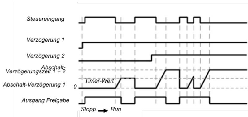
Abb. 81: Ablauf-/Timingdiagramm für den Funktionsblock Einstellbare Abschaltverzögerung mit Abschaltverzögerungszeit 1 und Abschaltverzögerungszeit 2
