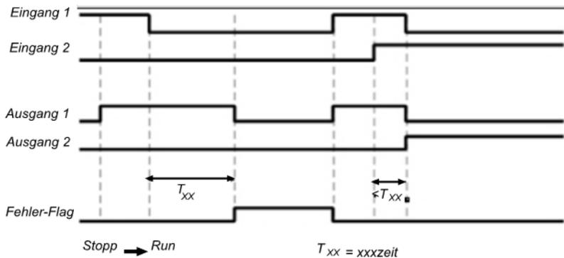
Abb. 93: Ablauf-/Timingdiagramm für den Funktionsblock Betriebsartenwahlschalter
