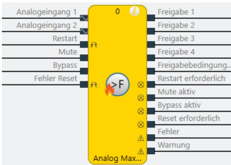
Abb. 193: Logische Anschlüsse für den Funktionsblock Analog Max Strömung
