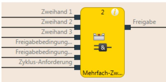
Abb. 111: Logische Anschlüsse für den Funktionsblock Mehrfach-Zweihand
