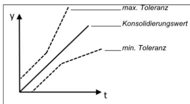
Abb. 168: Toleranz angegeben sowohl als absoluter Wert als auch als relativer Wert (Prozent), wobei die beiden Toleranzarten logisch ODER verknüpft sind.
