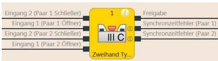
Abb. 109: Funktionsblockdiagramm für den Funktionsblock Zweihand Typ IIIC
