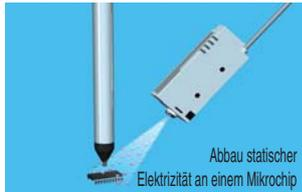
Abbau statischer Elektrizität an einem Mikrochip
