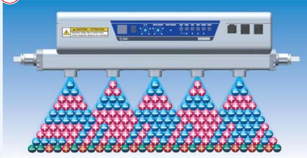
Positive- und Negative-Ionen werden gleichzeitig emittiert, so dass diese zu gleichen Anteilen das Werkstück erreichen.
