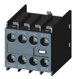
AUX.SWITCH BLOCK,FRONT,1NO+3NC, CURR.PATH: 1NO, 1NC, 1NC, 1NC, FOR CONTACTOR RELAYS, SZ S00, SCREW TERMINAL 53 / 54,61 / 62,71 / 72,81 / 82
