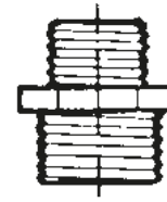
Nippel, reduziert, mit Außengewinde.
