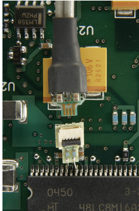
InfiniiMax ZIF tip soldered on board
