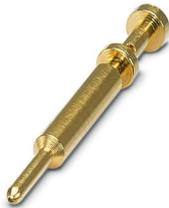
Crimpkontakt, Stift, gedreht, Kontaktdurchmesser: 1 mm, Crimpbereich: 0,5 mm<sup>2</sup> ... 1,5 mm<sup>2</sup>, Artikel ist bleifrei nach RoHS II ohne Ausnahme 6c (Pb < 0,1 %)
