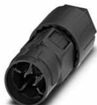
QUICKON Leitungsverbinder, mit einer QUICKON-Mutter, schwarz, 4+PE-polig, 2,5 mm<sup>2</sup> ... 6,0 mm<sup>2</sup> / 690 V / 40 A, für Kabeldurchmesser 9 mm ... 14 mm.
