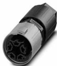
Steckverbinder, QUICKON-Anschluss, Polzahl: 4+PE, 2,5 mm<sup>2</sup> ... 6 mm<sup>2</sup>, 690 V, 40 A, schwarz, mit QUICKON-Mutter, Leitungsaußendurchmesser: 9 mm ... 14 mm
