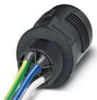
QUICKON-Wanddurchführung, 4+PE-polig, 2,5 mm<sup>2</sup>... 6,0 mm<sup>2</sup> / 690 V / 40 A, ohne QUICKON-Mutter, schwarz, M25-Anschlussgewinde mit 5 angeschweißten 6,0 mm<sup>2</sup> Leitungsadern, 0,5 m lang, am Ende glatt abgeschnitten.
