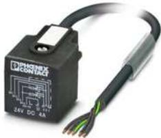
Sensor-/Aktor-Kabel, 5-polig, PVC, schwarz, freies Leitungsende, auf Ventilstecker AD (Druckschalter), mit 2 LEDs, Kabellänge: 1,5 m
