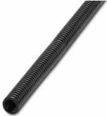
Schutzschlauch, Material: PA 6, UV-beständig: ja, flexibel, Schutzart: IP68, Farbe: schwarz, Brennbarkeitsklasse nach UL 94: HB, Innendurchmesser: 10 mm, Gesamtlänge: 50 m
