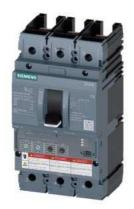
Leistungsschalter 3VA6 UL Frame 150 Schaltvermögenklasse E 200 kA @ 480 V 3-polig, Anlagenschutz ETU350, LSI, In=60A Überlastschutz Ir=24A ...60A Kurzschlussschutz Isd=1,5... 10 x Ir, Ii=12 x In ohne Anschluss
