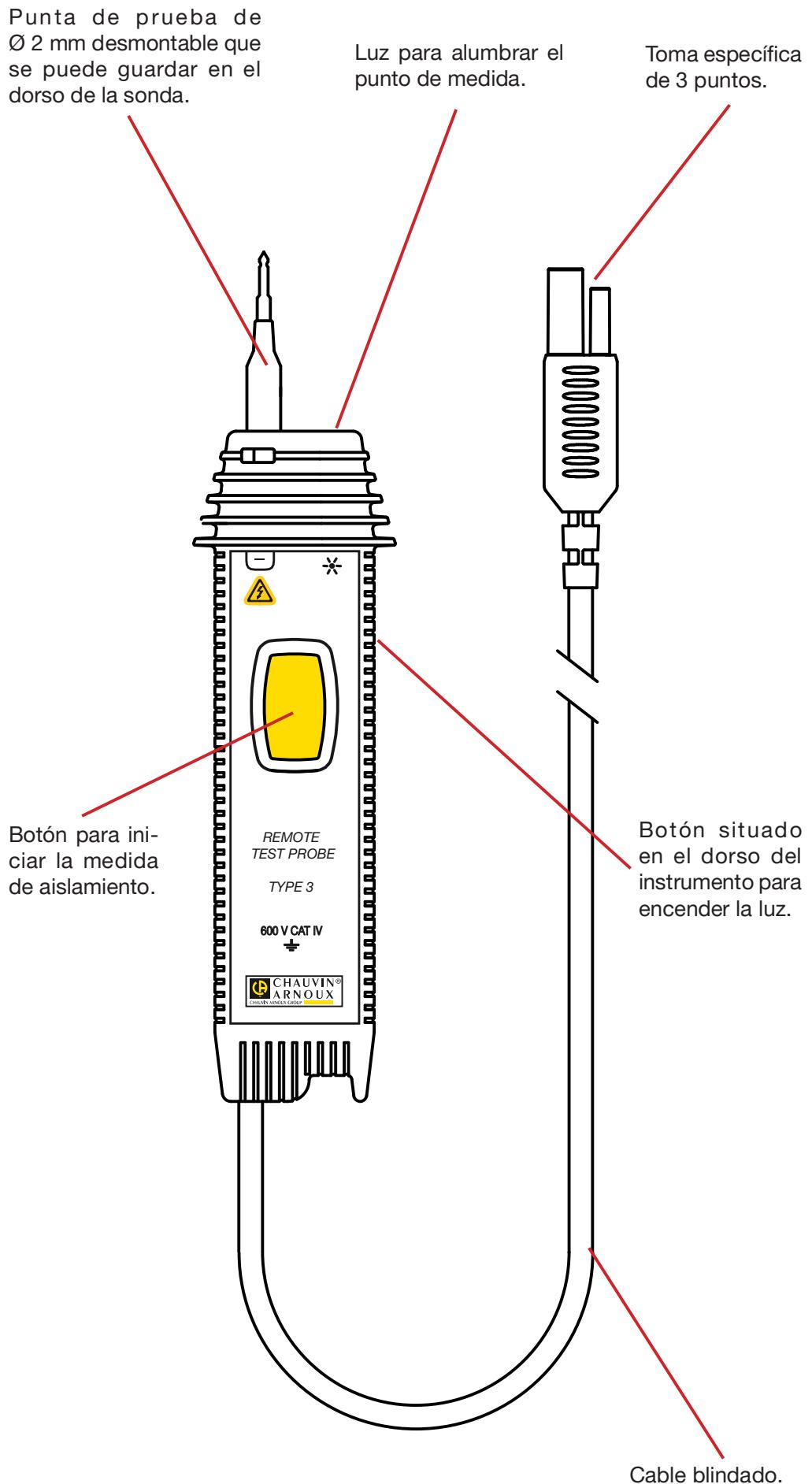
La sonda de telemando sirve para alejar el botón TEST y el terminal  $M\Omega$  del controlador de instalación para las medidas de aislamiento. De esta forma, el usuario puede sujetar la sonda de telemando en una mano, una punta de prueba en la otra e iniciar la medida.
