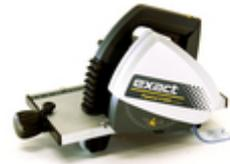
Die neue PipeCut V1000 bietet eine einfache Handhabung und einen großen Anwendungsbereich zum Trennen von Wickelfalzrohren. Speziell für die Klimatechnik ist dieses System eine enorme Arbeitserleichterung. Mit der V1000 werden Wickelfalzrohre mit einem Durchmesser von 75-1000 mm innerhalb weniger Sekunden getrennt.
