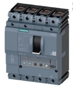
Leistungsschalter 3VA2 IEC Frame 100 Schaltvermögenklasse M Icu=55kA @ 415V 4-polig, Anlagenschutz ETU350, LSI, In=100A Überlastschutz Ir=40A...100A Kurzschlussschutz Isd=1,5...10 x Ir, Ii=12 x In N-Leiterschutz einstellbar (OFF, 50%, 100%) Klemmenanschluss
