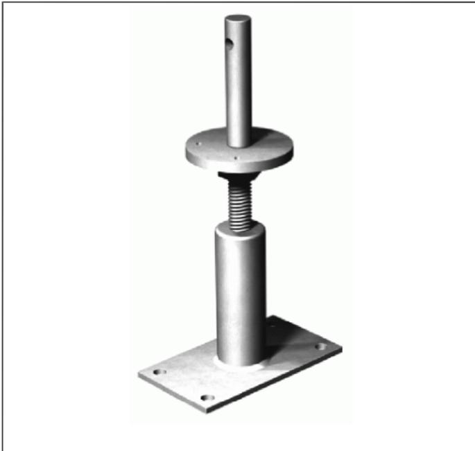
Die PGS Stützenfüße sind zur Aufnahme von vertikalen und horizontalen Lasten ausgelegt. Die Anbindung an die Stütze erfolgt durch eine Bohrung  $\varnothing$  24 mm. Die PGS werden mit Ankerbolzen am Betonfundament angeschlossen.
