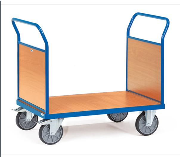
Stahlrohr und Profilstahl geschweißt, pulverbeschichtet RAL 5007, Plattform Holzwerkstoffplatte, Oberfläche Buchendekor. 2 Stirnwände aus Holzwerkstoffplatte, Oberfläche Buchendekor, Wände 500 mm hoch. 2 Lenk- und 2 Bockrollen, TPE-Bereifung, Naben mit Rillenkugellager. Feststeller an den Lenkrollen, gemäß der Europäischen Norm EN 1757-3 (Sicherheit von Plattformwagen).
