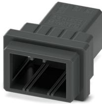
Leiterplattenstecker, Farbe: schwarz, Nennstrom: 8 A, Bemessungsspannung (III/2): 160 V, Kontaktart: Stift, Anzahl der Reihen: 2, Polzahl: 6, Artikelfamilie: DD31H 2,2/..-FH, Rastermaß: 3,81 mm, Anschlussart: Crimpanschluss, Anschlussrichtung Leiter/Platine: 0 °, Pin-Layout: Lineares Pinning, Rasthaken: - ohne Rasthaken, Stecksystem: CONNEXIS DD, Verriegelung: Rastverriegelung, Befestigungsart: Rastnase, Verpackungsart: verpackt im Karton
