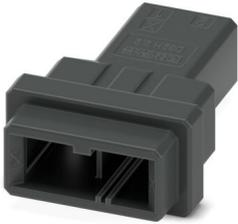
Leiterplattenstecker, Farbe: schwarz, Nennstrom: 8 A, Bemessungsspannung (III/2): 320 V, Kontaktart: Stift, Anzahl der Reihen: 1, Polzahl: 2, Artikelfamilie: D32H 2,2/...-FH, Rastermaß: 5,08 mm, Anschlussart: Crimpanschluss, Anschlussrichtung Leiter/Platine: 0 °, Pin-Layout: Lineares Pinning, Rasthaken: - ohne Rasthaken, Stecksystem: CONNEXIS D, Verriegelung: Rastverriegelung, Befestigungsart: Rastnase, Verpackungsart: verpackt im Karton
