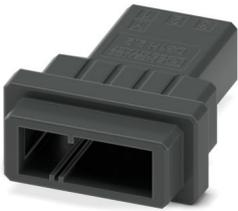
Leiterplattenstecker, Farbe: schwarz, Nennstrom: 8 A, Bemessungsspannung (III/2): 160 V, Kontaktart: Stift, Anzahl der Reihen: 1, Polzahl: 3, Artikelfamilie: D31H 2,2/...-FH, Rastermaß: 3,81 mm, Anschlussart: Crimpanschluss, Anschlussrichtung Leiter/Platine: 0 °, Rasthaken: - ohne Rasthaken, Stecksystem: CONNEXIS D, Verriegelung: Rastverriegelung, Befestigungsart: Rastnase, Verpackungsart: verpackt im Karton
