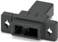
Durchführungsstecker, Farbe: schwarz, Nennstrom: 8 A, Bemessungsspannung (III/2): 320 V, Kontaktart: Stift, Anzahl der Reihen: 1, Polzahl: 2, Artikelfamilie: D32H 2,2/...-PT, Rastermaß: 5,08 mm, Anschlussart: Crimpanschluss, Anschlussrichtung Leiter/Platine: 0 °, Rasthaken: - ohne Rasthaken, Stecksystem: CONNEXIS D, Ausrichtung Steckgesicht: Standard, Verriegelung: Rastverriegelung, Befestigungsart: Rastnase, Verpackungsart: verpackt im Karton
