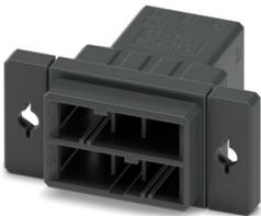
Durchführungsstecker, Farbe: schwarz, Nennstrom: 8 A, Bemessungsspannung (III/2): 320 V, Kontaktart: Stift, Anzahl der Reihen: 2, Polzahl: 6, Artikelfamilie: DD32H 2,2/..-PT, Rastermaß: 5,08 mm, Anschlussart: Crimpanschluss, Anschlussrichtung Leiter/Platine: 0 °, Rasthaken: - ohne Rasthaken, Stecksystem: CONNEXIS DD, Ausrichtung Steckgesicht: Standard, Verriegelung: Rastverriegelung, Befestigungsart: Rastnase, Verpackungsart: verpackt im Karton
