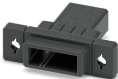
Durchführungsstecker, Farbe: schwarz, Nennstrom: 8 A, Bemessungsspannung (III/2): 160 V, Kontaktart: Stift, Anzahl der Reihen: 1, Polzahl: 3, Artikelfamilie: D31H 2,2/...-PT, Rastermaß: 3,81 mm, Anschlussart: Crimpanschluss, Anschlussrichtung Leiter/Platine: 0 °, Rasthaken: - ohne Rasthaken, Stecksystem: CONNEXIS D, Ausrichtung Steckgesicht: Standard, Verriegelung: Rastverriegelung, Befestigungsart: Rastnase, Verpackungsart: verpackt im Karton
