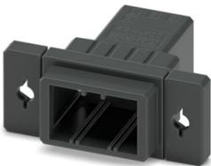
Durchführungsstecker, Farbe: schwarz, Nennstrom: 8 A, Bemessungsspannung (III/2): 160 V, Kontaktart: Stift, Anzahl der Reihen: 2, Polzahl: 6, Artikelfamilie: DD31H 2,2/...-PT, Rastermaß: 3,81 mm, Anschlussart: Crimpanschluss, Anschlussrichtung Leiter/Platine: 0 °, Pin-Layout: Lineares Pinning, Rasthaken: - ohne Rasthaken, Stecksystem: CONNEXIS DD, Ausrichtung Steckgesicht: Standard, Verriegelung: Rastverriegelung, Befestigungsart: Rastnase, Verpackungsart: verpackt im Karton
