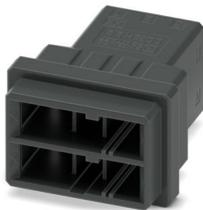
Leiterplattenstecker, Farbe: schwarz, Nennstrom: 8 A, Bemessungsspannung (III/2): 320 V, Kontaktart: Stift, Anzahl der Reihen: 2, Polzahl: 6, Artikelfamilie: DD32H 2,2/..-FH, Rastermaß: 5,08 mm, Anschlussart: Crimpanschluss, Anschlussrichtung Leiter/Platine: 0 °, Rasthaken: - ohne Rasthaken, Stecksystem: CONNEXIS DD, Verriegelung: Rastverriegelung, Befestigungsart: Rastnase, Verpackungsart: verpackt im Karton
