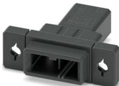
Leiterplattenstecker, Farbe: schwarz, Nennstrom: 8 A, Bemessungsspannung (III/2): 320 V, Kontaktart: Stift, Anzahl der Reihen: 1, Polzahl: 2, Artikelfamilie: D32H 2,2/...-PT, Rastermaß: 5,08 mm, Anschlussart: Crimpanschluss, Anschlussrichtung Leiter/Platine: 0 °, Pin-Layout: Lineares Pinning, Rasthaken: - ohne Rasthaken, Stecksystem: CONNEXIS D, Ausrichtung Steckgesicht: Standard, Verriegelung: Rastverriegelung, Befestigungsart: Rastnase, Verpackungsart: verpackt im Karton
