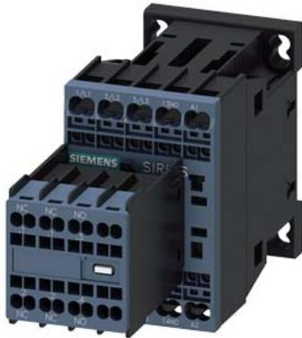
Leistungsschütz, AC-3e/AC-3, 12 A, 5,5 kW / 400 V, 3-polig, AC 230 V, 50/60 Hz, Hilfskontakte: 2 S + 2 Ö, Federzuganschluss, Baugröße: S00, Hilfsschalter lösbar
