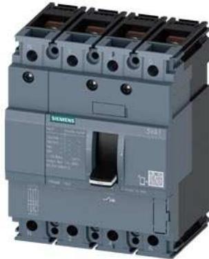
Leistungsschalter 3VA1 IEC Frame 160 Schaltvermögenklasse H Icu=70kA @ 415V 4-polig, Anlagenschutz TM210, FTFM, In=80A Überlastschutz Ir=80A fest eingestellt Kurzschlusschutz Ii=10 x In N-Leiter ungeschützt Schraubenflächanschluss
