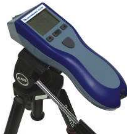
Montage des Laser-Tachometers auf einem Stativ
