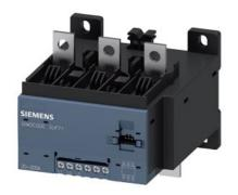
Strom-/Spannungserfassungsmodul V2; Einstellstrom 20...200 A, Spannungserfassung bis 690 V, Baubreite 120 mm, Schienenanschluss, erfordert Grundgerät pro V PB, pro V MR, pro V PN oder pro V EIP
