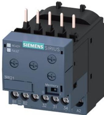
Überwachungsrelais, anbaubar an Schütz 3RT2, Baugröße S00 Basic, analog einstellbar Scheinstromüberwachung 1,6-16 A, 20-400 Hz, 2-phasig Versorgung 24-240 V AC/DC 1 Wechsler Überwachung auf Stromüber- und Unterschreitung Phasenausfall, Drahtbruch mit oder ohne Fehlerspeicher Anlaufverzögerung 0-60 s Störspitzenausblendung 0-30 s Schalthysterese 6% Schraubanschlusstechnik
