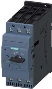
Leistungsschalter Baugröße S2 für Starterkombination Bemessungsstrom 65 A N-Auslöser 845 A Schraubanschluss Standardschaltvermögen
