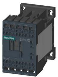
CONTACTOR, AC-3, 4KW/400V, 1NO, AC 230V, 50/60 HZ, 3-POLE, SZ S00 SPRING-LOADED TERMINAL
