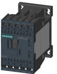
CONTACTOR, AC-3, 7.5KW/400V, 1NC, AC 24V 50/60HZ, 3-POLE, SZ S00 SPRING-LOADED TERMINAL
