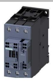
CONTACTOR,AC3:22KW/400V, 1NO+1NC, 230V AC 50HZ, 3-POLE, SIZE S2, SPRING-TYPE TERMINAL UPRIGHT MOUNTING POSITION
