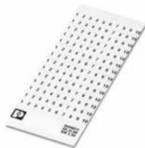
Kennzeichnungskarte, weiß, beschriftet, längs: fortlaufende Zahlen 1 ... 10, 11 ... 20 usw. bis 91 ... 99, Montageart: kleben, für Klemmenbreite: 3,5 mm, Schriftfeldgröße: 3,5 x 2,8 mm
