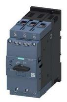
Leistungsschalter Baugröße S3 für den Motorschutz, CLASS 10 A-Auslöser 57...75 A N-Auslöser 975 A Schraubanschluss Standardschaltvermögen mit querliegenden Hilfsschalter 1S+1Ö
