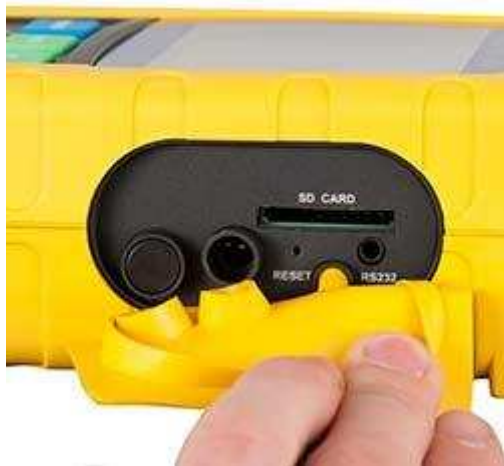
Die Anschlüsse vom 4-Kanal-Vibrationsdatenlogger PCE-VM 5000.
