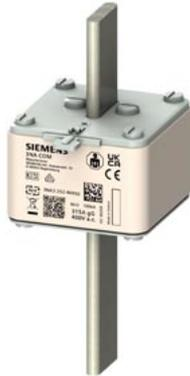
NH-Sicherungseinsatz 3NA COM mit Messfunktion mit drahtloser Kommunikation Baugroesse 2 224A Un 400V Betriebsklasse gG ohne Elektronikmodul spannungsführende Griffflaschen Stirnkennmelder
