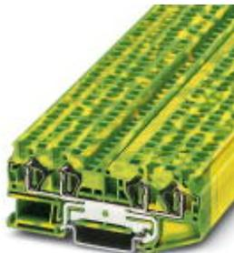
Schutzleiter-Reihenklemme, Anschlussart: Zugfederanschluss, Querschnitt: 0,08 mm<sup>2</sup> - 6 mm<sup>2</sup>, AWG: 28 - 10, Breite: 6,2 mm, Farbe: grün-gelb, Montageart: NS 35/7,5, NS 35/15
