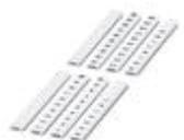
Zackband flach, Streifen, weiß, beschriftet, längs bedruckt: ungerade Zahlen 1-19, 21-39 usw. bis 81-99, Montageart: Verrasten in flacher Schildchennut, für Klemmenbreite: 6,2 mm, Schriftfeldgröße: 5,15 x 6,15 mm
