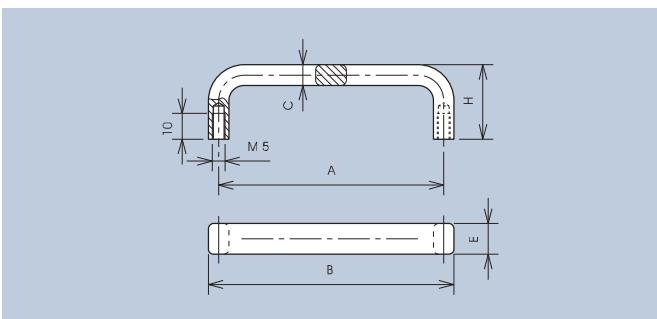
Einschließlich Zylinderschrauben-M5 x 12 und Scheiben.
