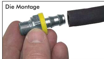
Schlauch rechtwinklig abschneiden. Zur leichten Montage Nippel mit Seiflösung benetzen.
