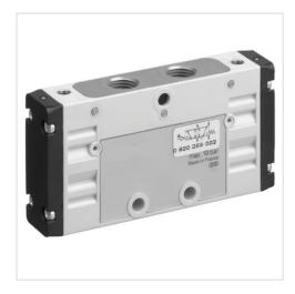
Bauart Schieberventil Betätigung pneumatisch Dichtprinzip weich dichtend 1100 l/min Durchflusswert Qn -0,9 ... 10 bar Betriebsdruck min./max. Steuerdruck min./max. 3 ... 10 bar -10 ... 50 °C Umgebungstemperatur min./max. -10 ... 50 °C Mediumstemperatur min./max. Medium Druckluft Max. Partikelgröße 5 µm Ölgehalt der Druckluft 0 ... 5 mg/m<sup>3</sup>
