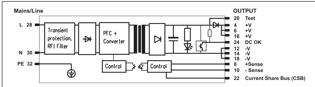
Pin 20 (Test): Ausgangsspannung intern vor der Entkoppeldiode zu Messzwecken herausgeführt
