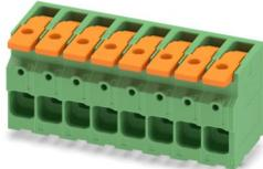
Leiterplattenklemme, Nennstrom: 76 A, Bemessungsspannung (III/2): 1000 V, Nennquerschnitt: 16 mm<sup>2</sup>, Anzahl der Potenziale: 8, Anzahl der Reihen: 1, Polzahl pro Reihe: 8, Artikelfamilie: LPT 16/, Rastermaß: 10 mm, Anschlussart: Hebel-Push-in-Anschluss, Montage: Wellenlöten, Anschlussrichtung Leiter/Platine: 0 °, Farbe: grün, Pin-Layout: Zick-Zack-Pinning W, Pinlänge [P]: 3,6 mm, Verpackungsart: verpackt im Karton
