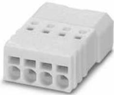
Leiterplattenstecker, Nennquerschnitt: 0,5 mm<sup>2</sup>, Farbe: weiß, Nennstrom: 6 A, Bemessungsspannung (III/2): 160 V, Kontaktoberfläche: Zinn, Kontaktart: Stift (male), Anzahl der Potenziale: 4, Anzahl der Reihen: 1, Polzahl: 4, Anzahl der Anschlüsse: 4, Artikelfamilie: PTSM 0,5/..-PI WH, Rastermaß: 2,5 mm, Anschlussart: Push-in-Federanschluss, Anschlussrichtung Leiter/Platine: 0 °, Stecksystem: COMBICON PTSM, Verriegelung: ohne, Befestigungsart: ohne, Verpackungsart: verpackt im Karton
