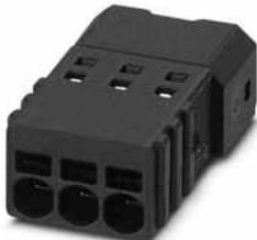
Leiterplattenstecker, Nennquerschnitt: 0,5 mm<sup>2</sup>, Farbe: schwarz, Nennstrom: 6 A, Bemessungsspannung (III/2): 160 V, Kontaktoberfläche: Zinn, Kontaktart: Stift (male), Anzahl der Potenziale: 4, Anzahl der Reihen: 1, Polzahl: 4, Anzahl der Anschlüsse: 4, Artikelfamilie: PTSM 0,5/...-PI, Rastermaß: 2,5 mm, Anschlussart: Push-in-Federanschluss, Anschlussrichtung Leiter/Platine: 0 °, Stecksystem: COMBICON PTSM, Verriegelung: ohne, Befestigungsart: ohne, Verpackungsart: verpackt im Karton
