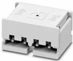
Leiterplattenverbinder, Bemessungsspannung (III/2): 25 V, Nennquerschnitt: 0,34 mm<sup>2</sup>, Anzahl der Potenziale: 4, Anzahl der Reihen: 1, Polzahl pro Reihe: 4, Artikelfamilie: PTF 0,3/..-BB-H, Rastermaß: 1,9 mm, Montage: Direktstecktechnik, Farbe: weiß, Verpackungsart: verpackt im Karton. Für flexible Leiterplatten mit einer Breite von 8 mm und einer zulässigen Leiterplattendicke im Kontaktbereich von 0,15 mm ... 0,3 mm
