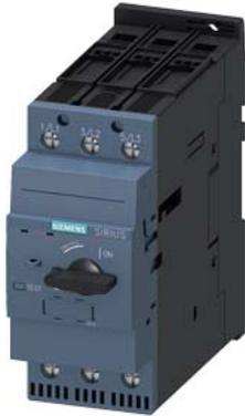
Leistungsschalter Baugröße S2 für Starterkombination Bemessungsstrom 36 A N-Auslöser 520 A Schraubanschluss erhöhtes Schaltvermögen
