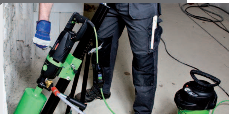
BST 182 V/S: auf vier Spezialkugeln gelagerter Schlitten
